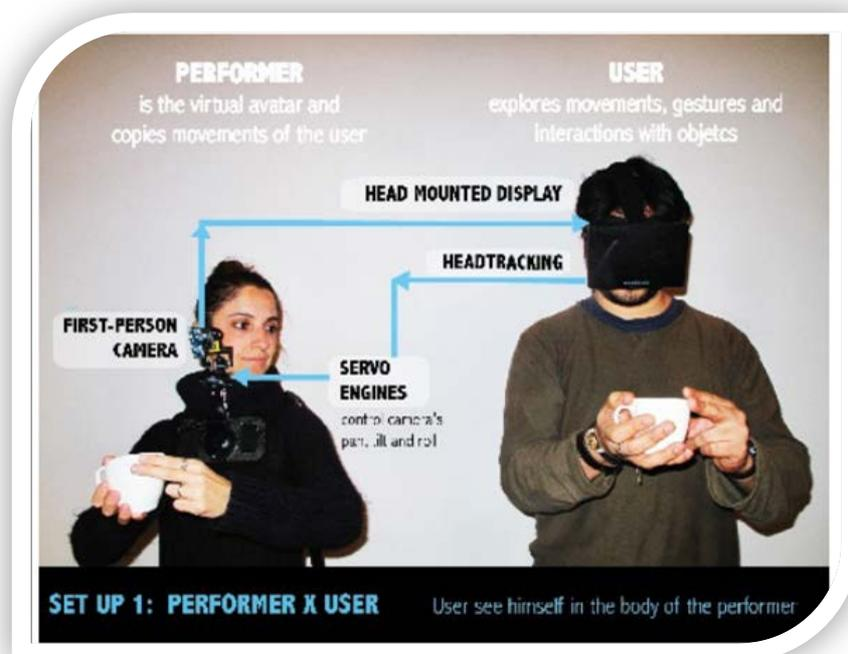
**Figura 28. Sistema Head Tracking MTBA**
