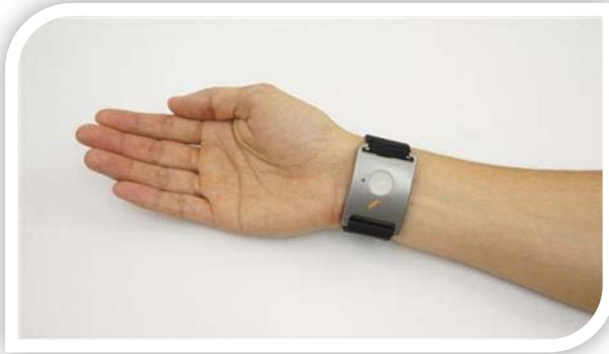
**Figura 16: Affective Q Sensor para medir la Respuesta Galvánica de la piel y la temperatura**
