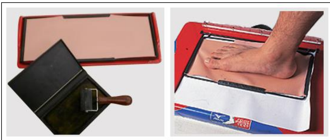
Figura 8. Pedígrafo para registrar la impresión plantar
