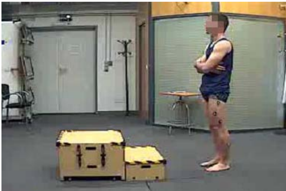
Figura 13: Posición para la calibración. (Imagen cedida por el Instituto de Biomecánica de Valencia).
