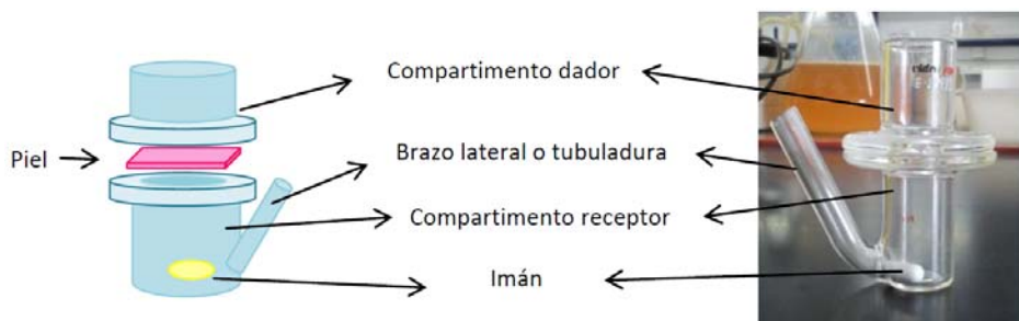
Figura 3.III.1. Esquema de los componentes de una célula de Franz
