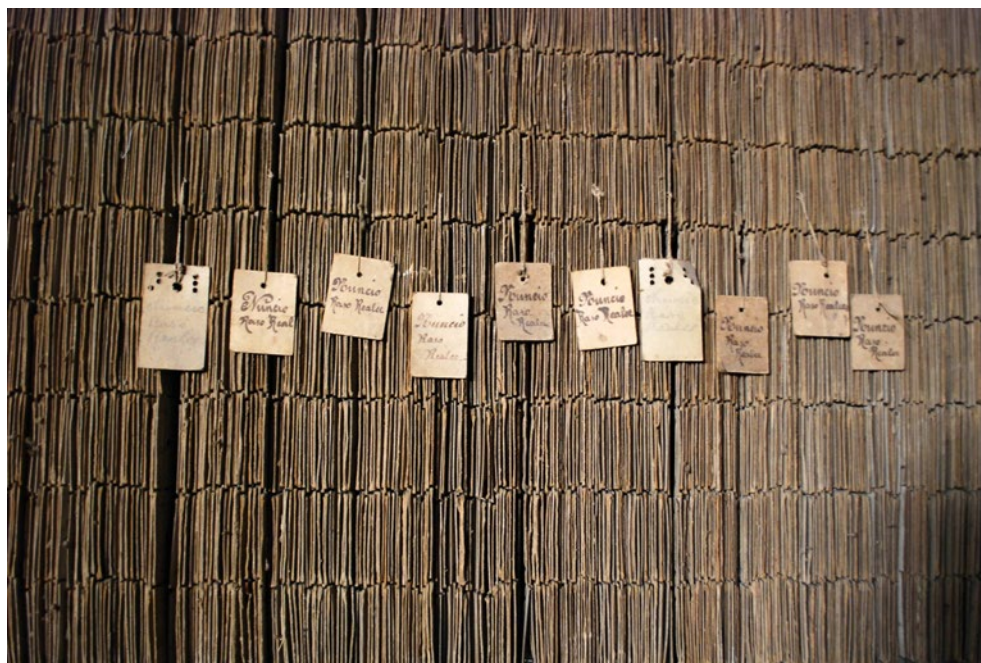
Cartones, con sus etiquetas originales, para telares, jacquard manuales. Siglo XIX. AMS.
