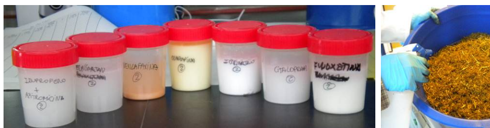
Figura 3.4. Preparación de la suspensión de fármacos para adicionarla con ayuda de un pulverizador a la mezcla inicial a compostar.
