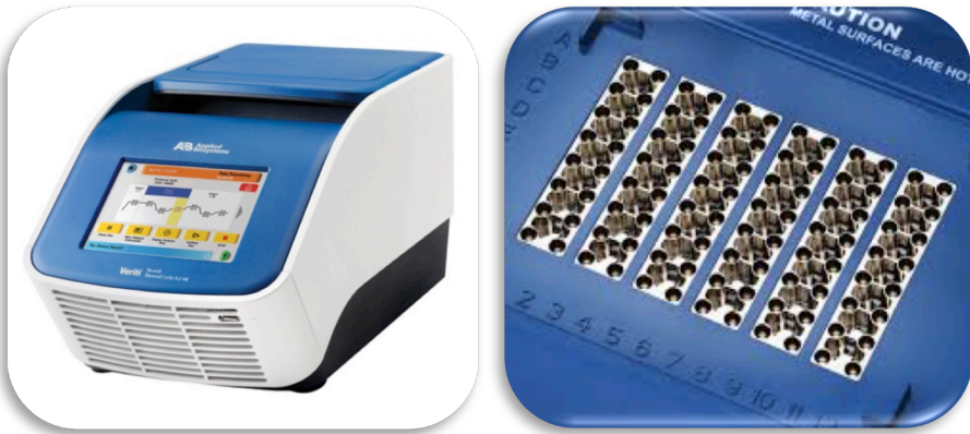
Figura 12.- Termociclador en el que se llevó a cabo el proceso de la PCR estándar (A). Pocillos en los que se depositaron las muestras de ADN y mezcla de reacción (B) (Tomada de www.thermofisher.com ).
