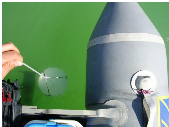
Figura 3.1. Lectura del disc de Secchi.
