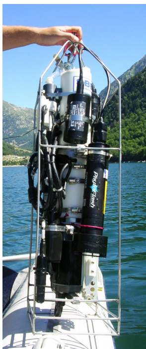
Figura 4.1. Sonda SBE19 amb el Phytoflash .
