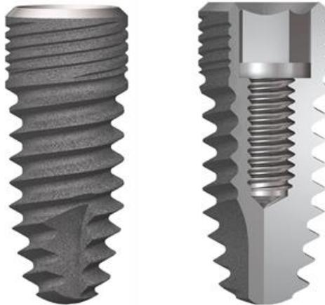
**Figura 5.2** Figura representativa del implante (GMI Frontier<sup>®</sup>, Ilerimplant, Lleida). Implantes de conexión interna hexagonal con toda la superficie exterior del implante tratada, exceptuando el bisel coronal que tiene un acabado pulido. El cuerpo del implante presenta un diseño ligeramente cónico con un perfil de rosca triangular, microespiras en la parte coronal y ápex cónico autoroscante.
