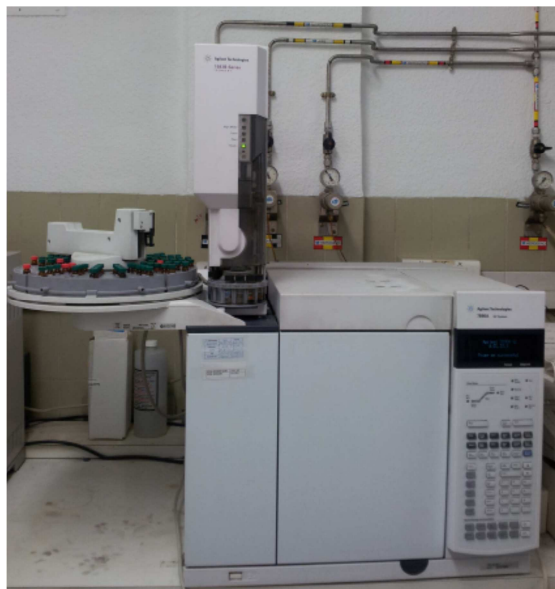
Figura 35. Cromatógrafo de gases con detector FID modelo Agilent 7890A utilizado para obtener los valores de referencia de las muestras de cocaína.
