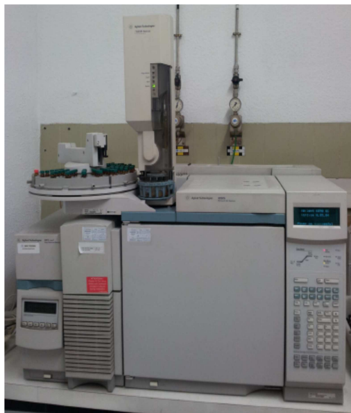
Figura 36. Cromatógrafo de gases acoplado a un espectrómetro de masas Agilent 6890N-5973 utilizado para el análisis cualitativo de las muestras de referencia.
