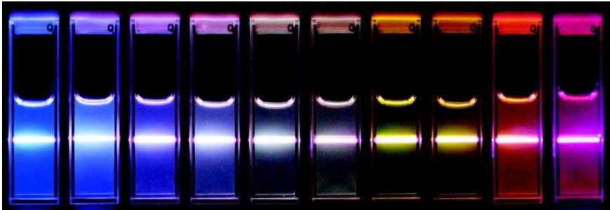
Figura 1.5. Modificación de la emisión UC a través del control de las cantidades de los dopantes en UCNP de composición \text{NaYF}_4:\text{Yb,Er,Tm} . Reimpreso con permiso de la referencia 108, Copyright del 2008 de la American Chemical Society.
