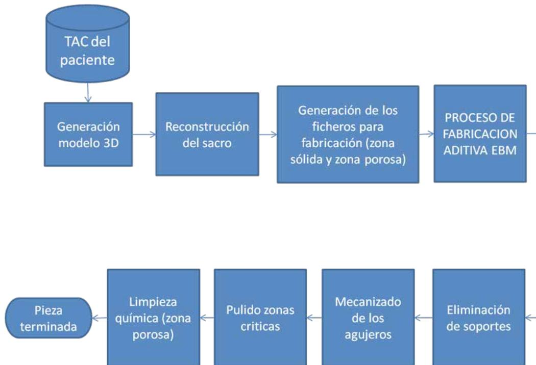
Ilustración 55. Resumen del proceso de diseño y fabricación de la pieza sustitutiva del sacro
