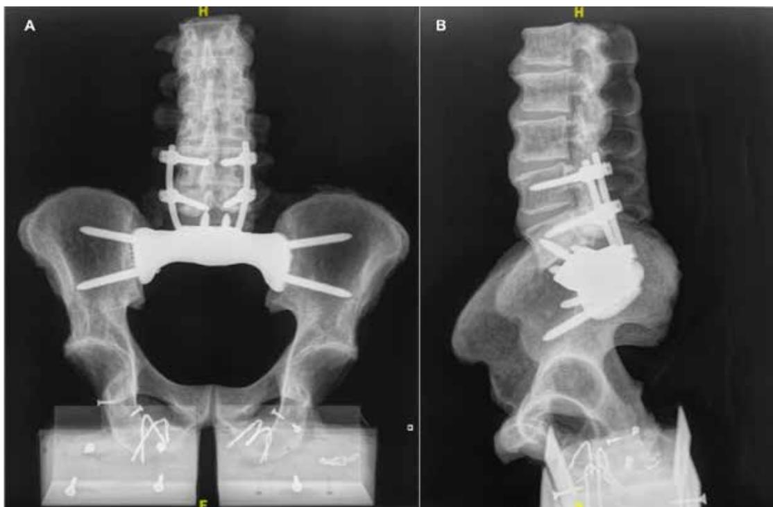
Ilustración 99. Radiografía simple del Modelo 5 tras el ensayo de fatiga. (A) Plano coronal. (B) Plano sagital.
