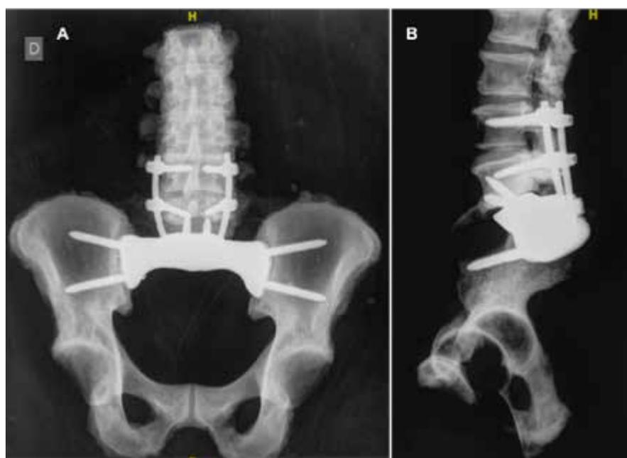
Ilustración 97. Radiografía simple del Modelo 5 tras su implantación en cadáver antes del ensayo de fatiga. (A) Visión antero-posterior. (B) Visión perfil.
