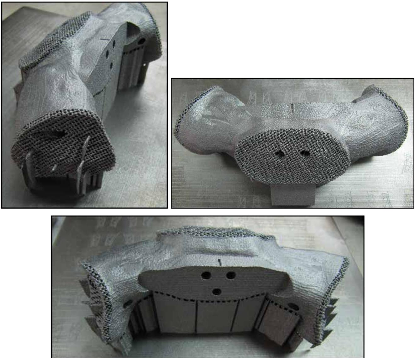
Ilustración 63. Diseño de la pieza sustitutiva de sacro con los soportes.
