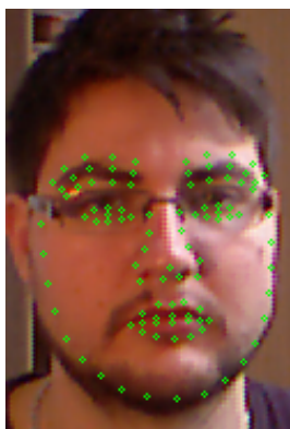
Figura 4.2: Algunos de los puntos en el plano 2D proporcionados por Microsoft Face Tracking SDK
