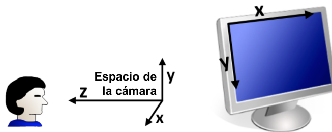
Figura 4.7: Espacio de la cámara del sensor Kinect medido en metros y representación en un espacio de vídeo estándar de 640x480 píxeles de resolución
