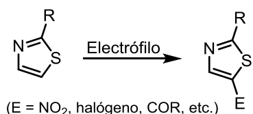
Figura 1.26.- Sustitución electrofílica sobre el anillo de tiazol.
