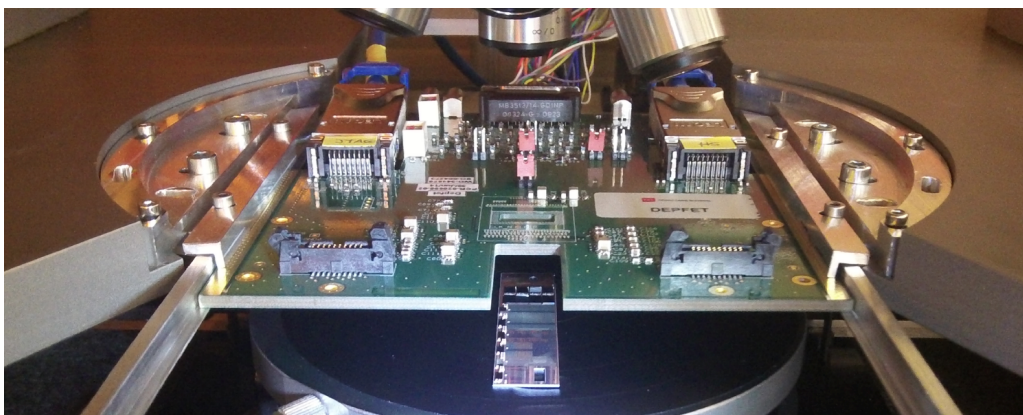
Figure 126: Fotografía de la tarjeta de puntas para el EMCM. El EMCM W17 – 4 esta situado en el “chuck” de la estación de pruebas.
