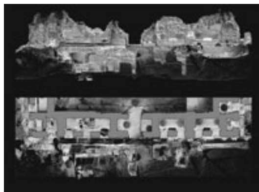
Levantamiento con escáner láser de la fachada Oeste de la Acrópolis de La Blanca durante la excavación de 6J2-Subestructura 2 (Planta y alzado). © Proyecto La Blanca 2015.
