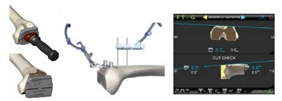
Figura 24. Esquema de los cortes femorales y comprobación de la precisión de los mismos.
