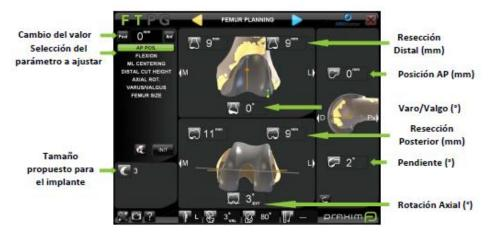
Figura 21. Pantalla de la planificación femoral.
