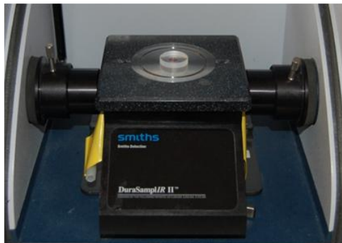
Figura 2.1. Accesorio con cristal de diamante/ZnSe de 9 reflexiones para muestras líquidas
