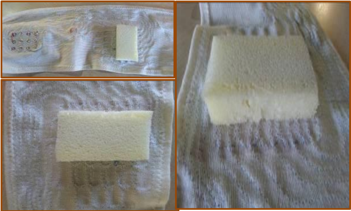
Figura 61. Prototipo 3: Con el fin de mejorar el contacto de los sensores con la zona a monitorizar del usuario y obtener unos valores de posición más cercanos a la realidad fue necesario añadir material viscoelástico.
