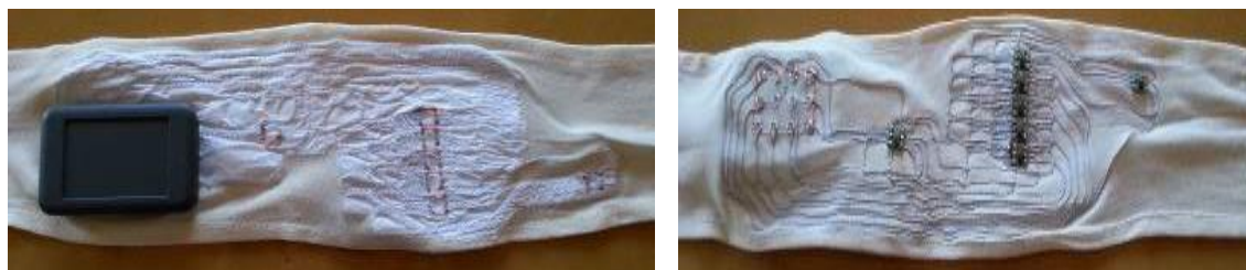
Figura 59. Prototipo 2: el desarrollado con los sensores en la parte interior del tejido (con contacto físico con el cuerpo del usuario).
