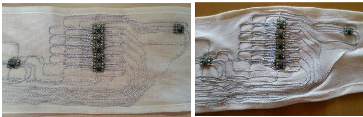
Figura 60. Detalle de integración de sensores
