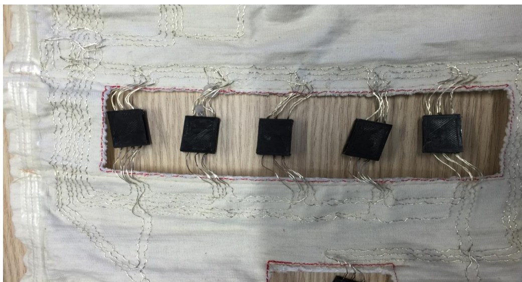
Figura 33. Detalle del sistema de cableado integrado en el textil.
