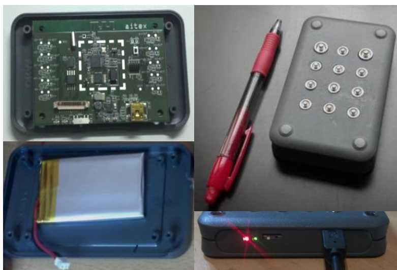
Figura 34. Detalle de la electrónica, la caja envolvente y el sistema de broches para su conexión con la faja.
