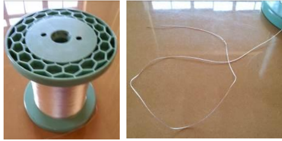
Figura 62. Hilo textil conductor con aislamiento
