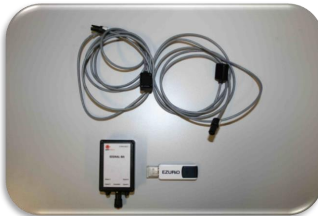
Figura 45. Equipo de acelerometría. Dos sensores, batería/transmisor, y receptor bluetooth.
