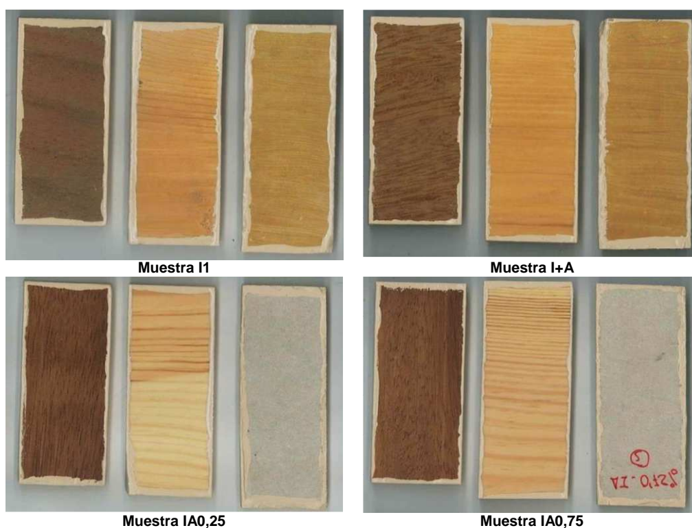
Figura 4.171. Muestras aplicadas y selladas sobre, IROKO, PINO y FIBROCEMENTO, antes del envejecimiento, 0 horas.
