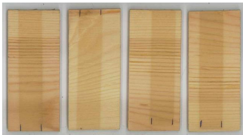
Figura 4.69. De izquierda a derecha muestras PR1 a PR4 tras 100 horas de exposición a lámpara de xenon.
