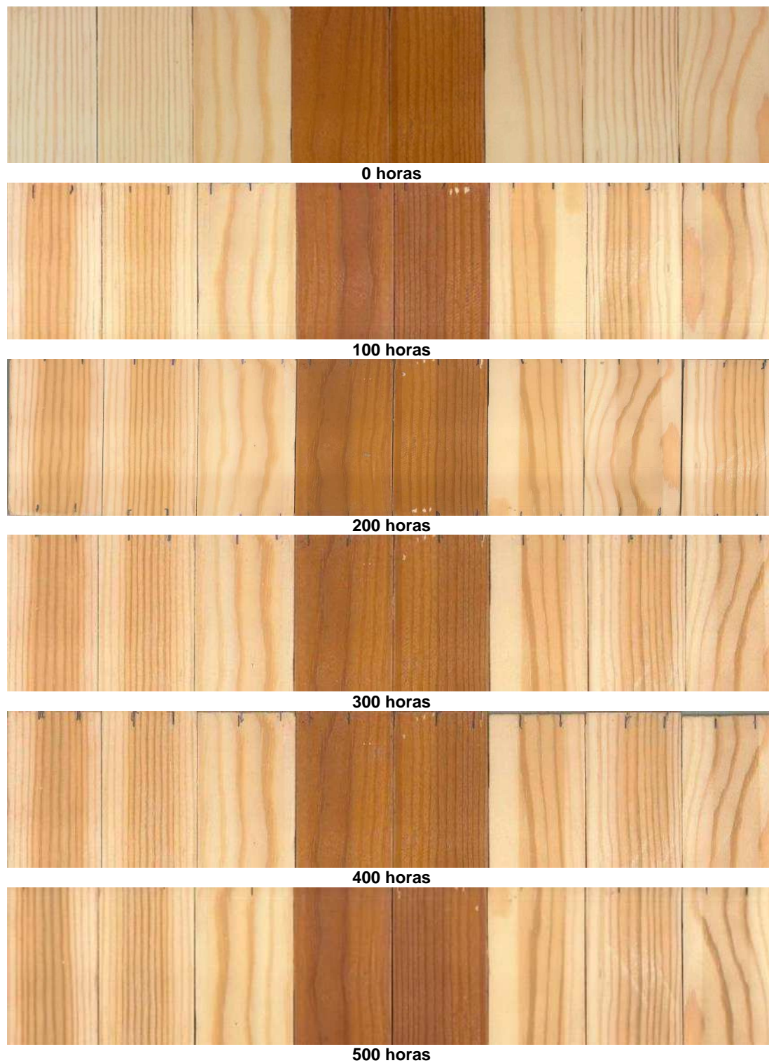
Figura 4.40. Muestras aplicadas sobre madera de PINO a diferentes periodos de exposición a la radiación de una lámpara de xenon en seco: de izquierda a derecha muestra sin recubrimiento – A – B – C – D - A1 - A2 –A3.
