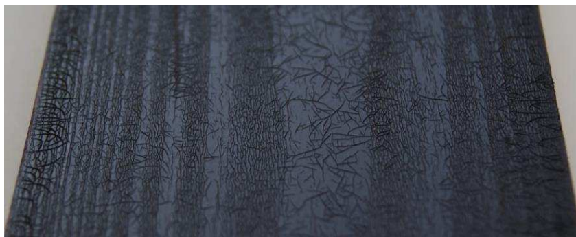
Figura 2.32. Formación de grietas de red al secarse el recubrimiento con nanopartículas aplicado sobre un soporte de madera. Las nanopartículas se adicionaron mediante post-aditivación a un recubrimiento base que no daba problemas en la aplicación.
