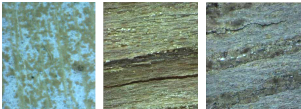
Figura 4.182. Detalle de las muestras I1, sobre fibrocemento, pino e iroko. Imágenes tomadas con equipo de análisis de imagen a 40x, tras 336 horas de envejecimiento.
