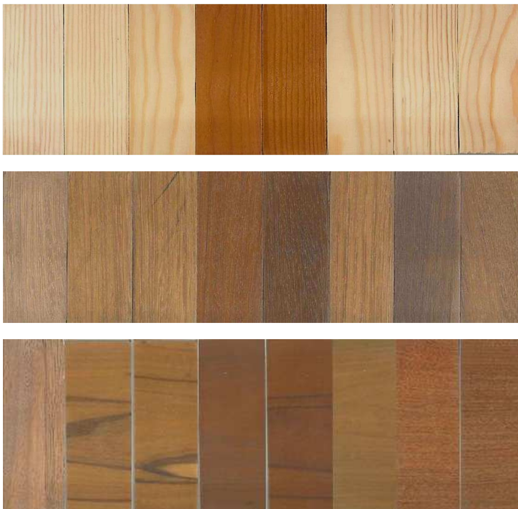
Figura 4.35. Muestras aplicadas sobre madera de PINO, IROKO e IPE. En las imágenes de izquierda a derecha: muestra sin recubrimiento – A – B – C – D - A1 - A2 –A3
