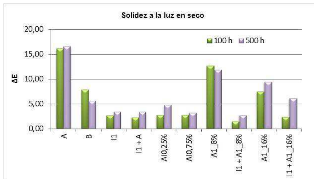
Figura 4.168. Comparación sistemas con aditivo de nanopartículas de \text{TiO}_2 , con el lasur base A y el lasur B con filtros orgánicos. Prueba solidez a la luz en seco.
