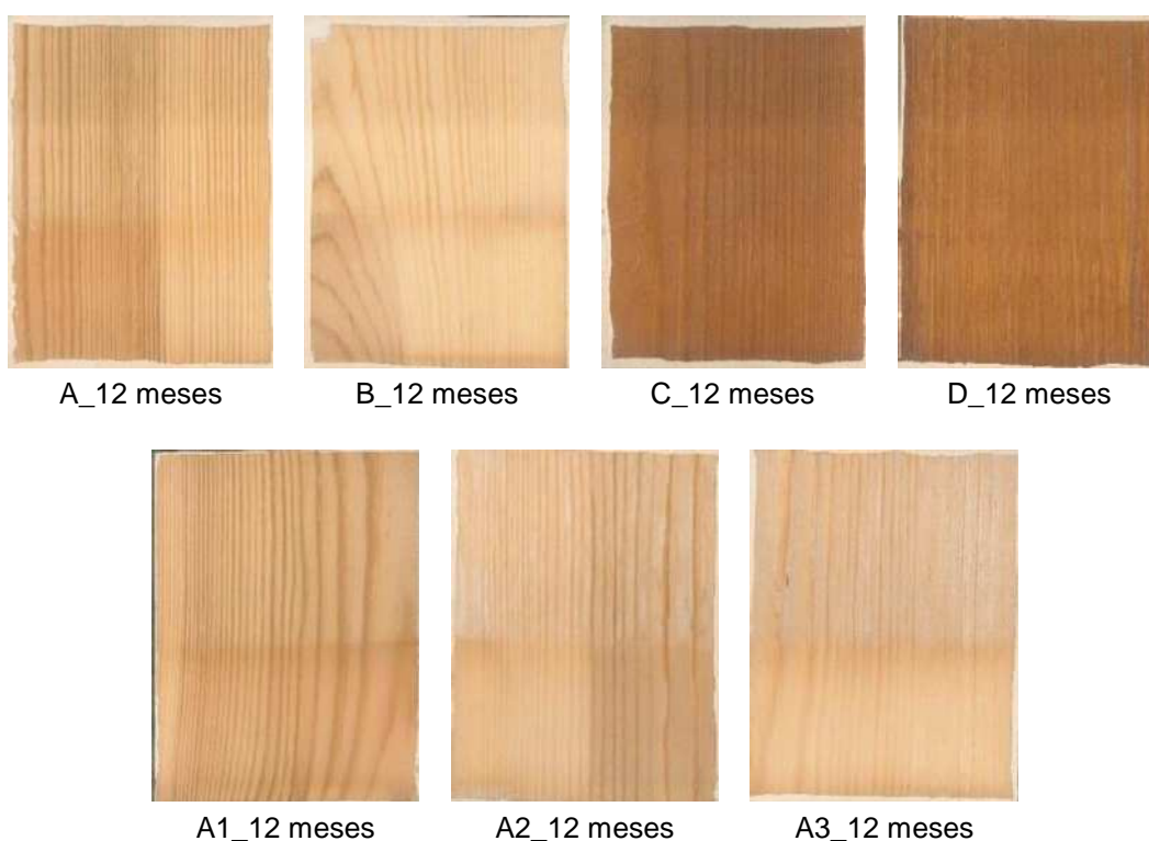
Figura 4.138. Probetas tras 12 meses de exposición. PINO. Arriba, de izquierda a derecha, muestras A - B - C - D. Abajo, de izquierda a derecha, muestras - A1- A2 - A3.
