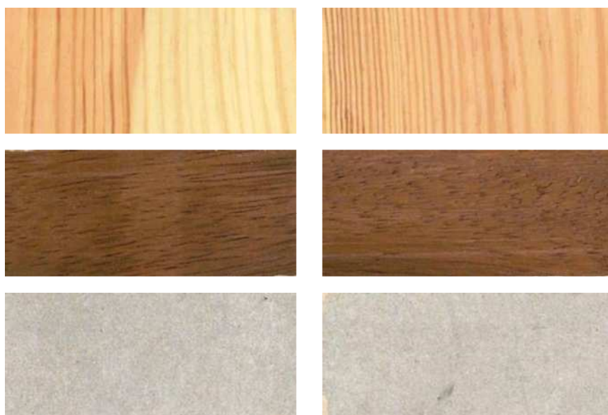
Figura 4.156. Izquierda, Muestras AI0,25%, producto con nanopartículas de TiO_2 utilizado como aditivo al 0,25% en el lasur A. Derecha, muestras AI0,75%, producto con nanopartículas de TiO_2 utilizado como aditivo al 0,75% en el lasur A. Soportes, de arriba abajo, PINO, IROKO y FIBROCEMENTO.
