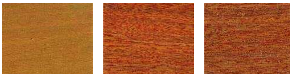
Figura 4.55. De izquierda a derecha detalle de las muestras: A1 con CeO_2 , A2 con ZnO y A3 con mezcla de CeO_2 y ZnO antes de la exposición a la radiación. Las manchas solo aparecen cuando se utiliza zinc.
