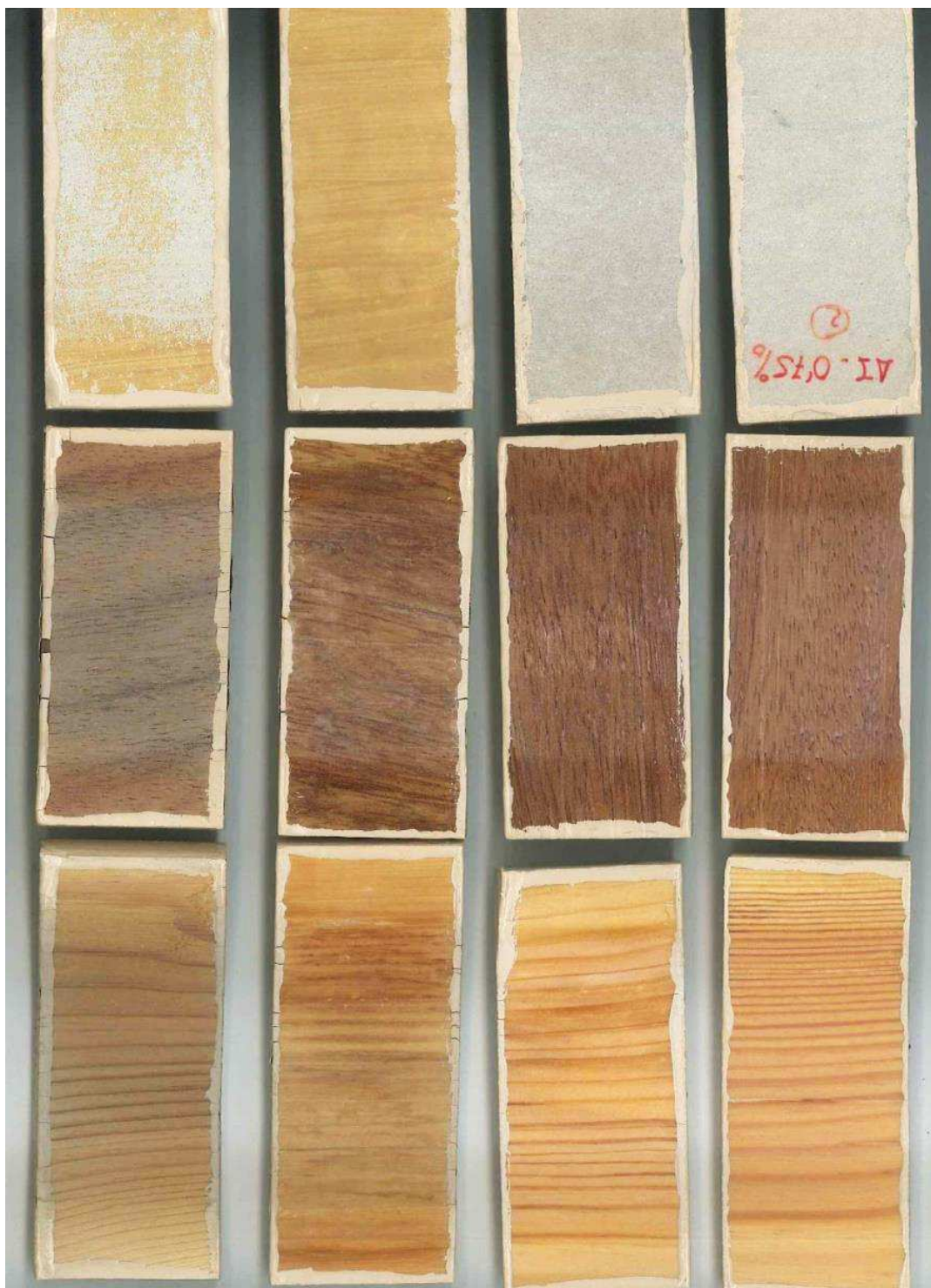
Figura 4.184. Muestras aplicadas sobre FIBROCEMENTO, PINO e IROKO tras 504h horas de exposición. De izquierda a derecha: muestra I1, muestra I+A, muestra AI 0,25, muestra AI0,75.
