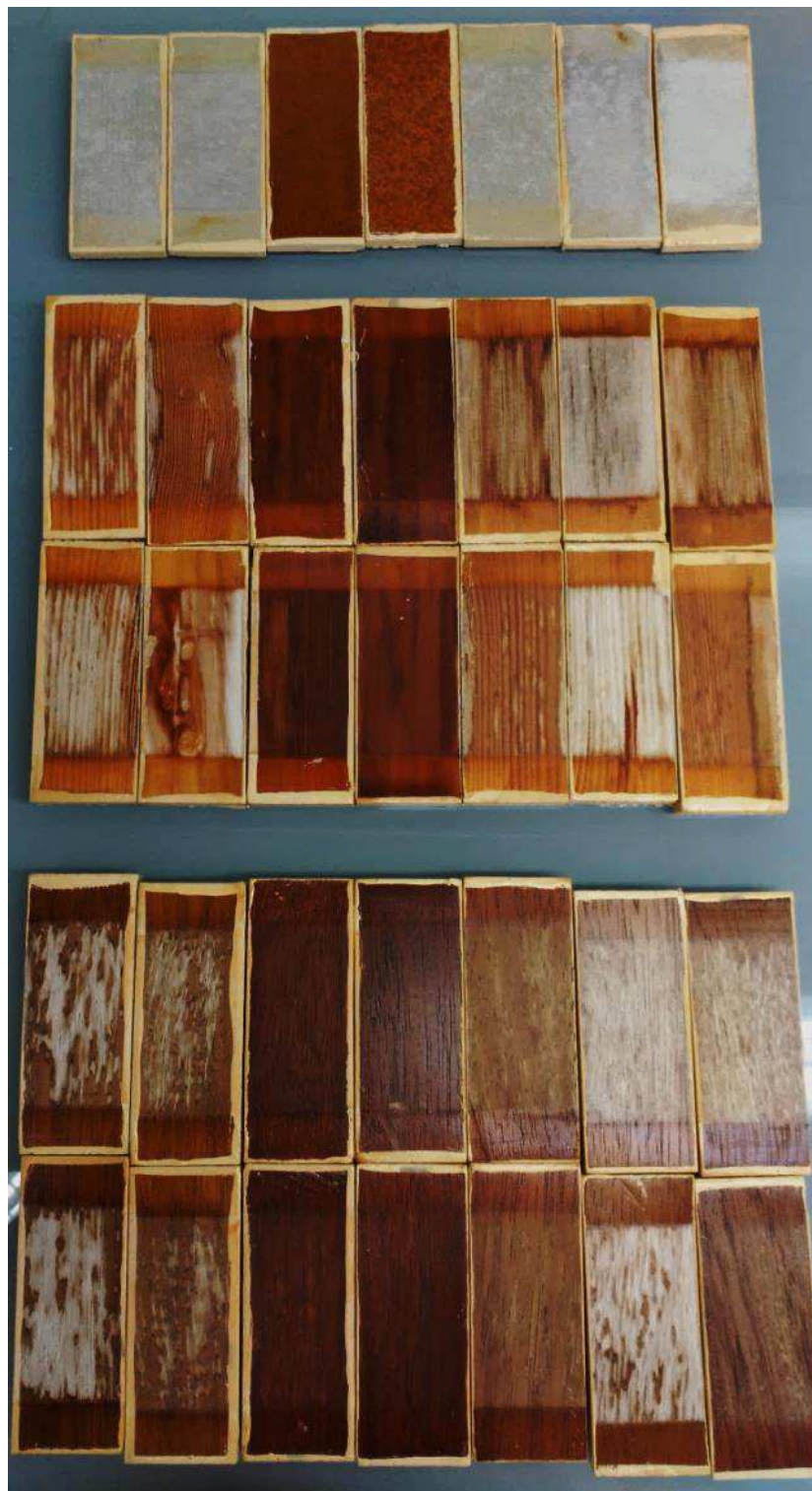
Figura 4.106. Muestras tras 2016 horas de ensayo. De izquierda a derecha, muestras A - B - C - D - A1 - A2 - A3. De arriba abajo, fibrocemento, pino, iroko.
