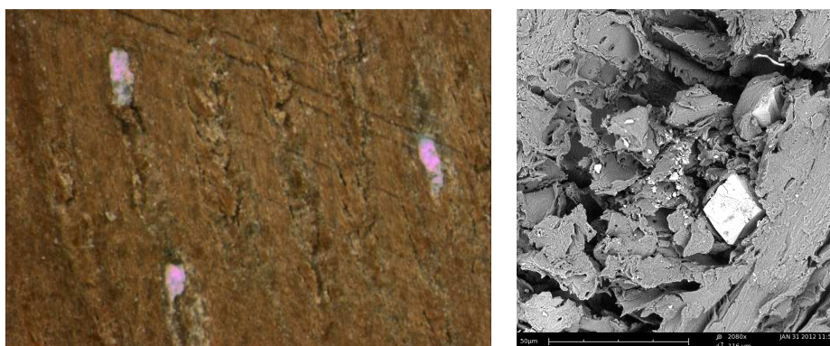
Figura 2.12. Depósitos de carbonato cálcico en madera de iroko. Izquierda imagen óptica a 25x. Derecha, imagen SEM, barra de escala 50 \mu\text{m} .
