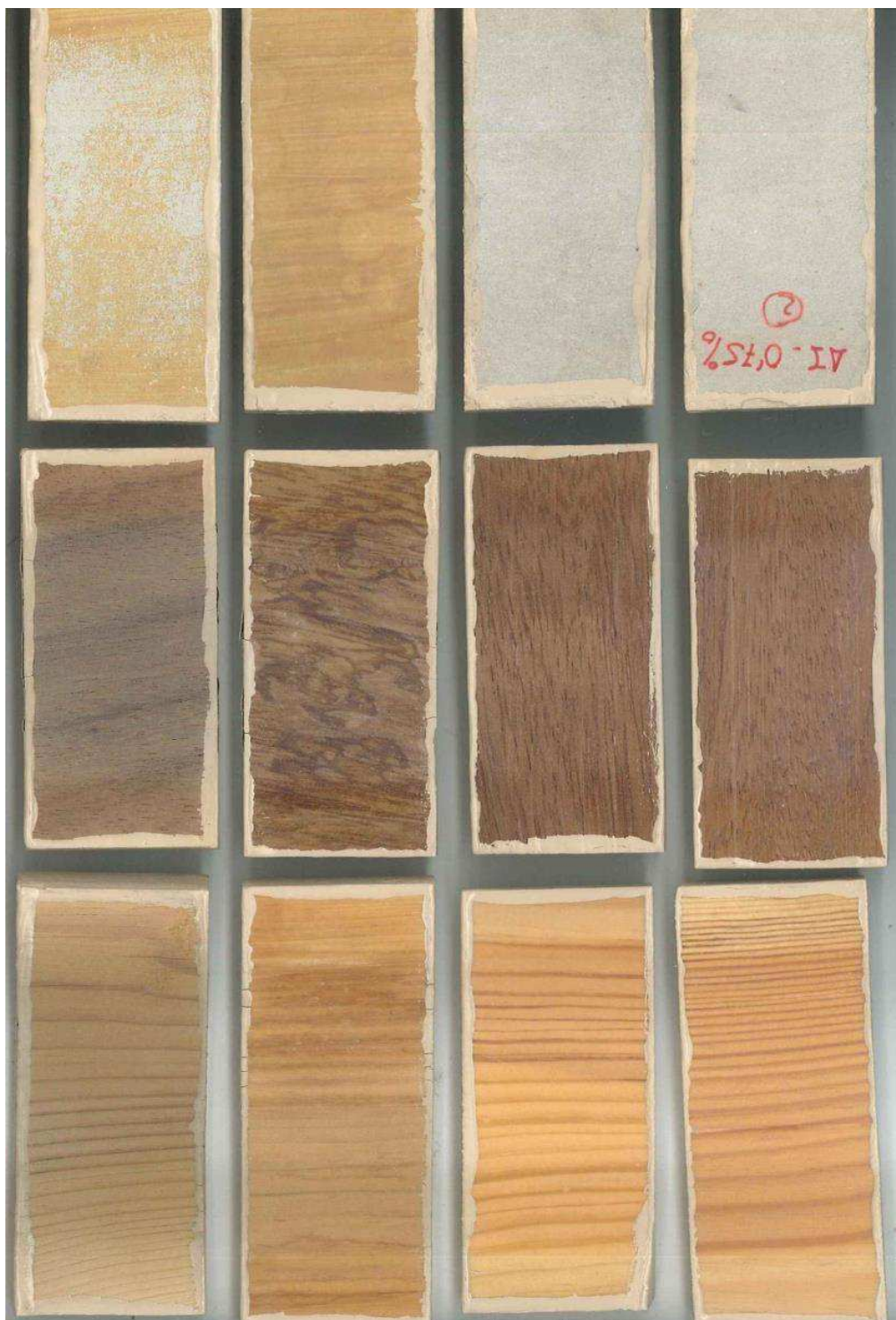
Figura 4.181. Muestras aplicadas sobre FIBROCEMENTO, PINO e IROKO tras 336h horas de exposición. De izquierda a derecha: muestra I1, muestra I+A, muestra AI 0,25, muestra AI0,75.
