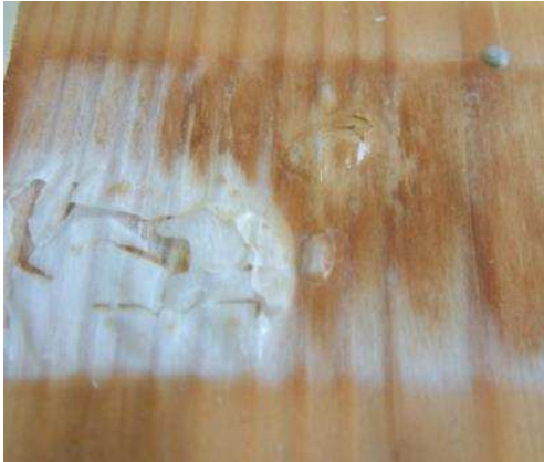
Formación de ampollas, cambio de color, fragilidad, cuarteamiento, deslaminación.
