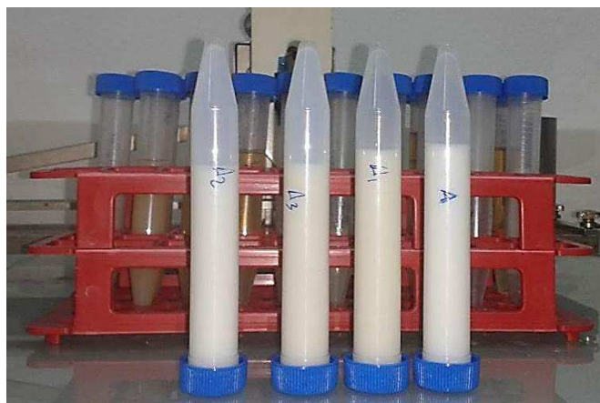
Figura 4.16. Ejemplo de aspecto homogéneo de las mezclas con nanopartículas comparado con el producto base tras 3 meses desde la mezcla después de la agitación. De izquierda a derecha, A2 - A3 -A1 - A.
