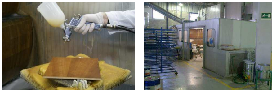
Figura 3.4. Aplicación de las muestras con pistola aerográfica en cabina presurizada. Planta piloto de acabados de AIDIMA.
