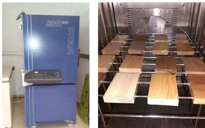
Figura 3.12. Cámara climática para ciclos de temperatura, Weiss SB11300.
