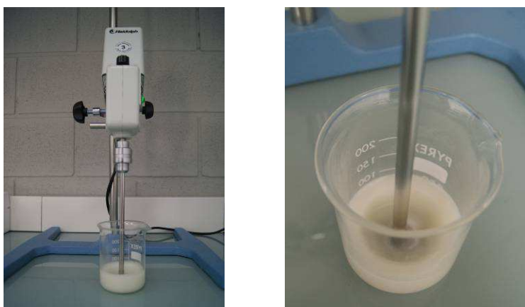
Figura 3.2. Incorporación de la dispersión de nanopartículas a la formulación base. Mezcla con agitador mecánico (Heidolph Instruments RZR1) 600rpm / 30min.
