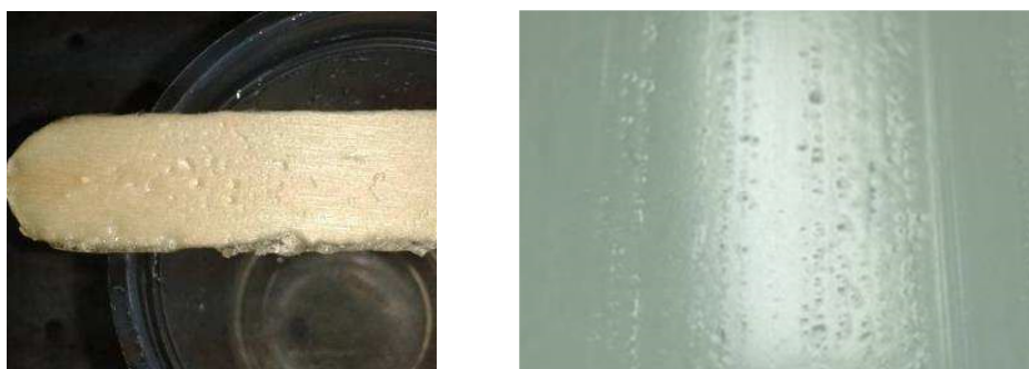
Figura 2.33. Ejemplo de efectos por incompatibilidad química entre aditivos de nanopartículas y el formulado base en mezclas de productos de curado UV con nanopartículas de óxido de silicio modificadas. Efecto de gelificación, izquierda, y de floculación con formación de grandes aglomerados, derecha.
