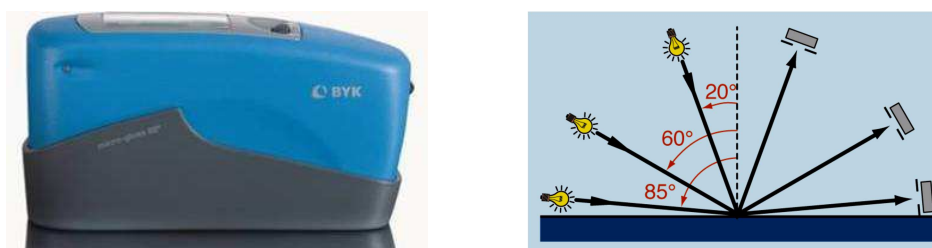
Figura 3.10. Brillómetro Micro-TRI-gloss y posibles ángulos de medida.
