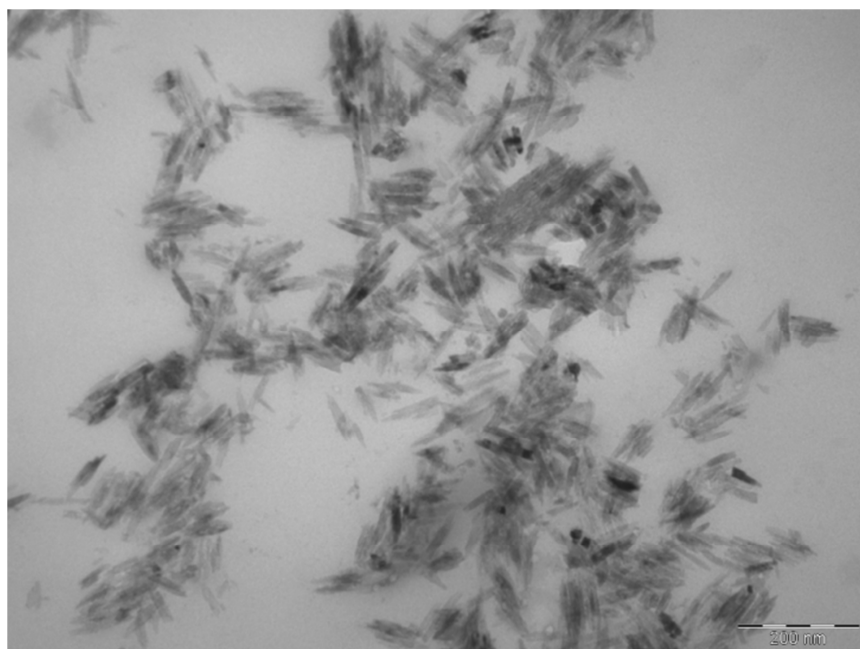
Figura 4.164. Imagen TEM a 100000x de la muestra Al 0,75 con nanopartículas de óxido de titanio, TiO 2 . Disposición de las nanopartículas en los puntos donde se concentran. Barra escala 200 nm.
