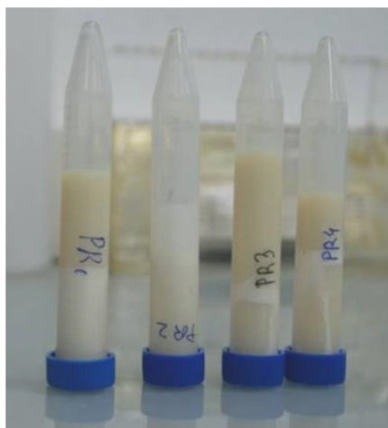
Figura 4.66. Muestras de algunas de las pruebas de procesado tras 3 meses. Separación de las cargas minerales.
