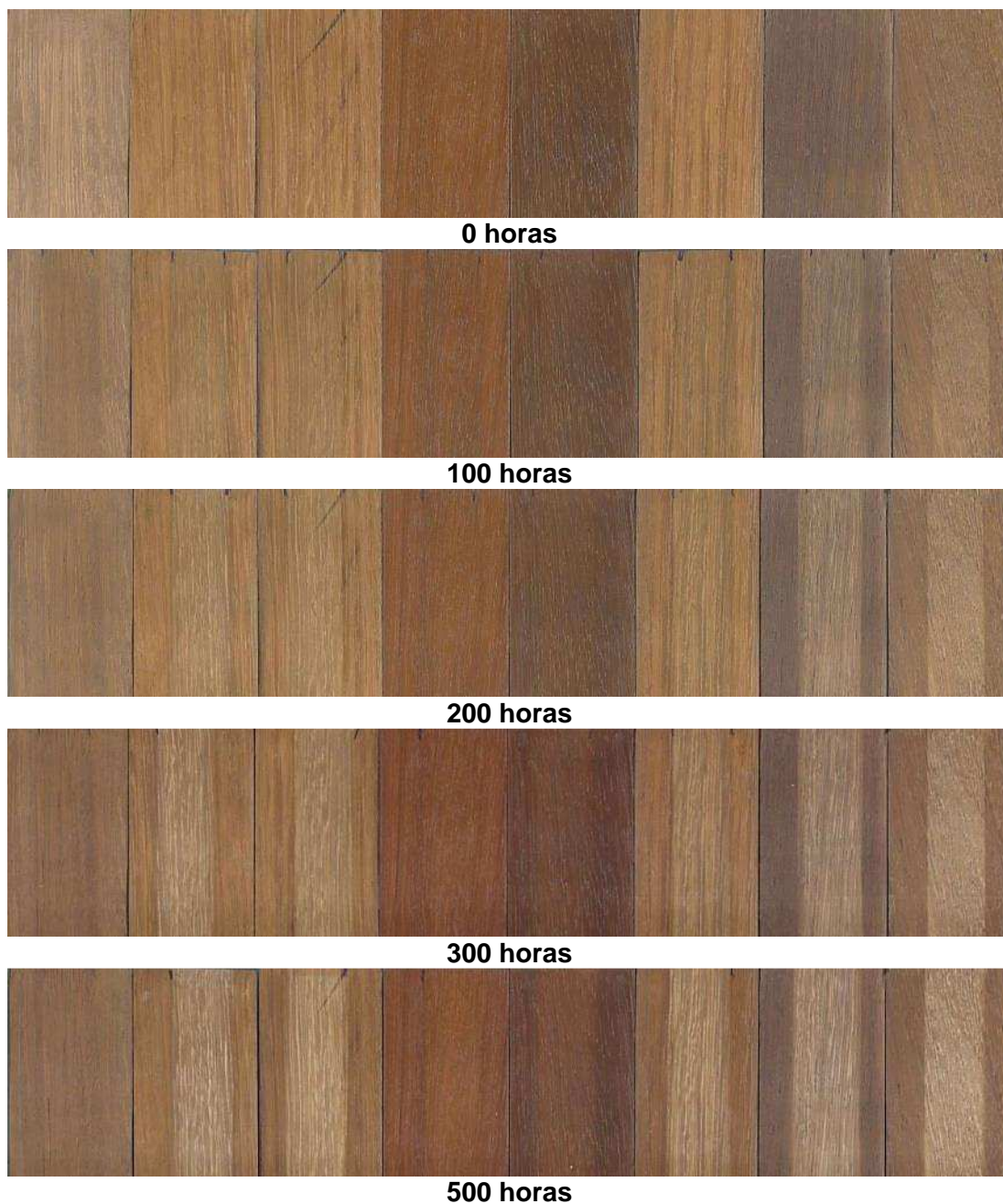
Figura 4.44. Muestras aplicadas sobre madera de IROKO a distintos periodos de exposición: muestra sin recubrimiento – A – B – C – D - A1 - A2 –A3.
