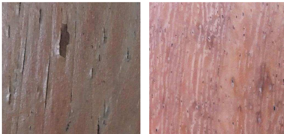
Figura 4.191. Detalle de las superficies en la muestra I+A sobre pino, izquierda, y de una de las réplicas IA 0,75 sobre iroko.
