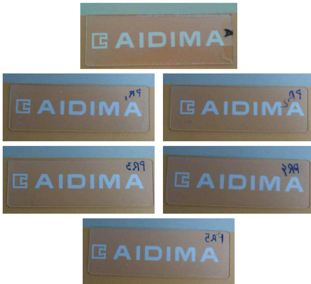
Figura 4.68. Aplicaciones sobre vidrio de los distintos formulados. No se aprecia diferencia en la transparencia.
