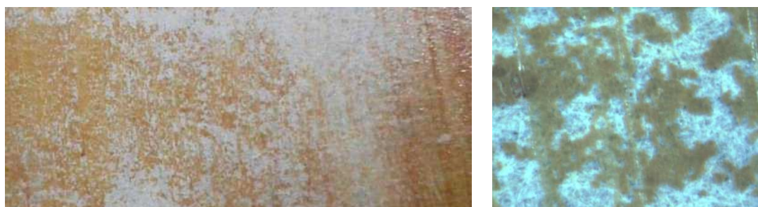
Figura 4.176. Detalle del defecto en la muestra I1 aplicada sobre FIBROCEMENTO tras 168 horas de exposición.
