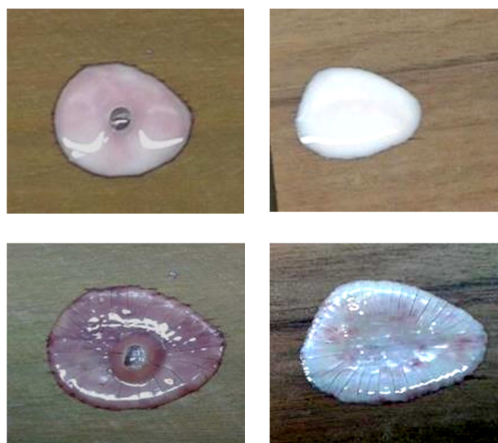
Figura 4.63. Prueba manchado de madera de IPE en crudo con aditivo de nanopartículas de ZnO. Coloración rojiza que aparece al depositar una gota del aditivo de nanopartículas de ZnO sobre madera de IPE en crudo.
