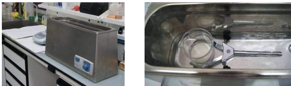
Figura 3.1. Tratamiento de la dispersión de nanopartículas mediante ultrasonidos (15'). Equipo de ultrasonidos (JP Selecta 3000617, W=200W).
