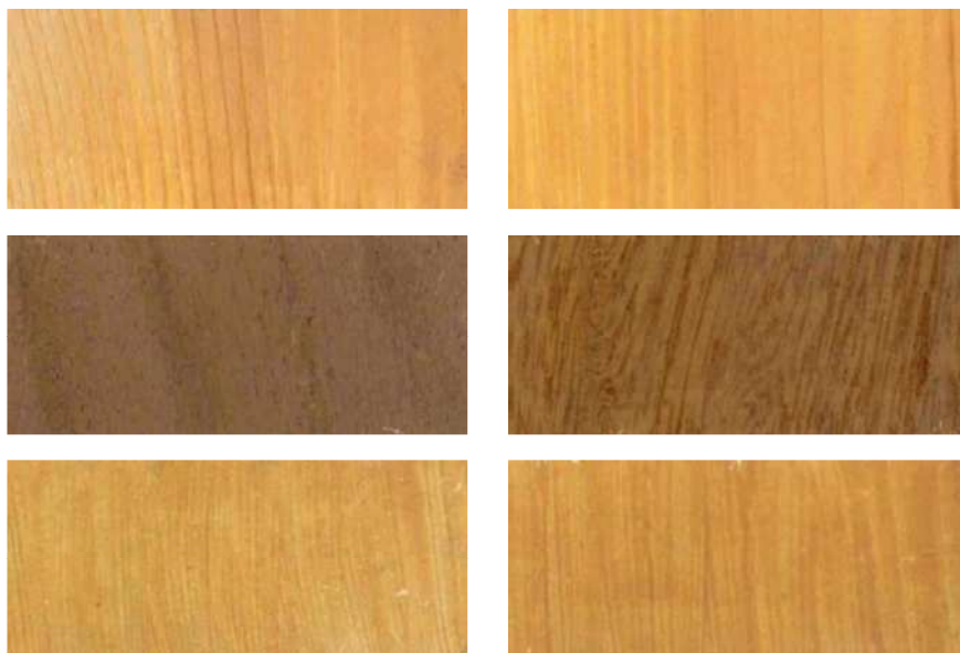
Figura 4.155. Izquierda, Muestras I1, producto con nanopartículas de TiO_2 utilizado como imprimación. Derecha, muestras I+A, producto con nanopartículas de TiO_2 utilizado como imprimación, aplicado directamente sobre los soportes, protegido con una capa de lasur A. Soportes, de arriba abajo, PINO, IROKO y FIBROCEMENTO.
