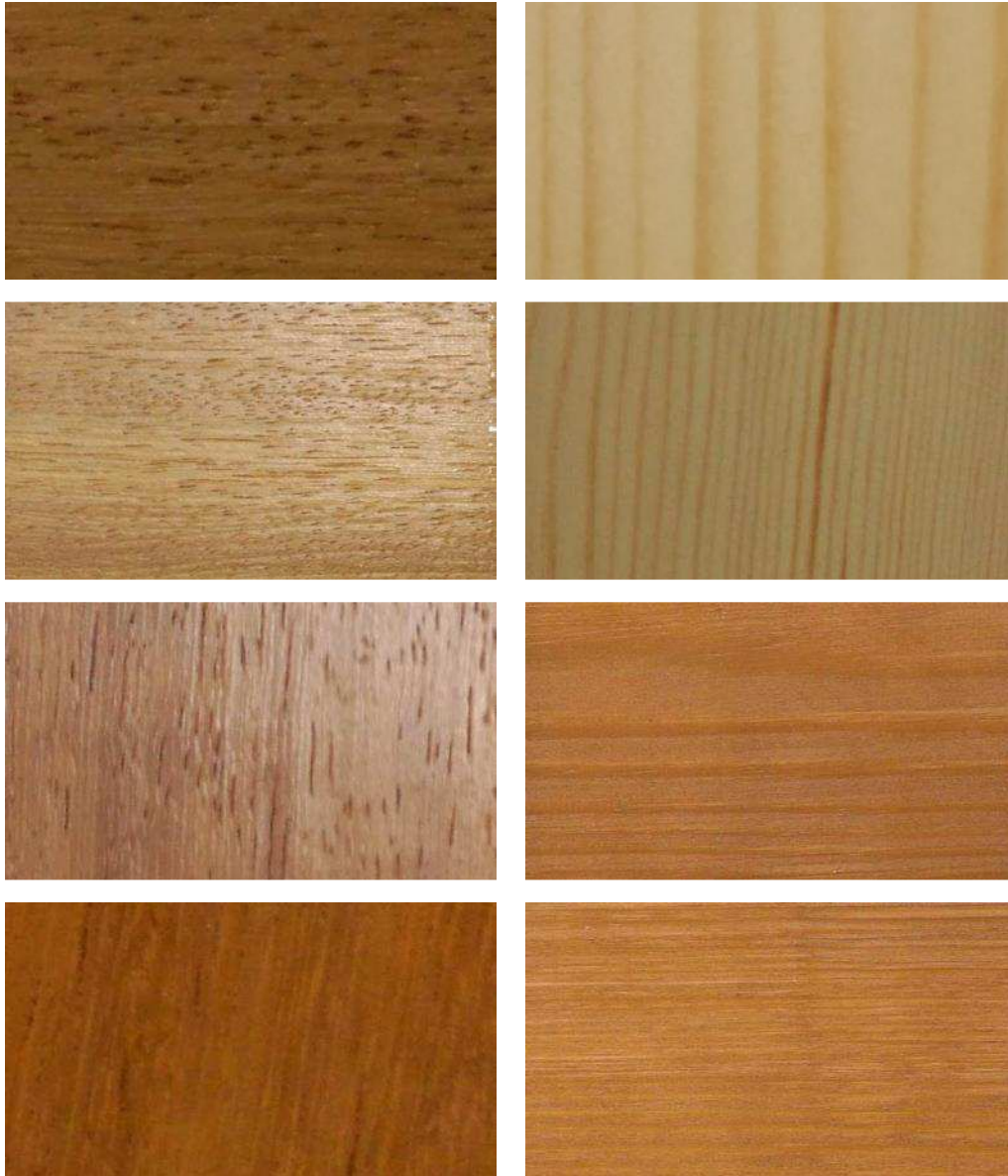
Figura 4.38. Detalle de la superficie de las muestras en iroko y en pino tras el ensayo de cold-check. De arriba abajo, muestras A, B, C, D.
