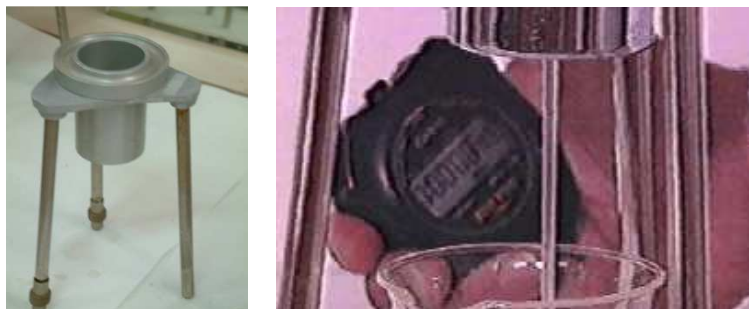
Figura 3.9. Copa viscosimétrica FORD nº4.
