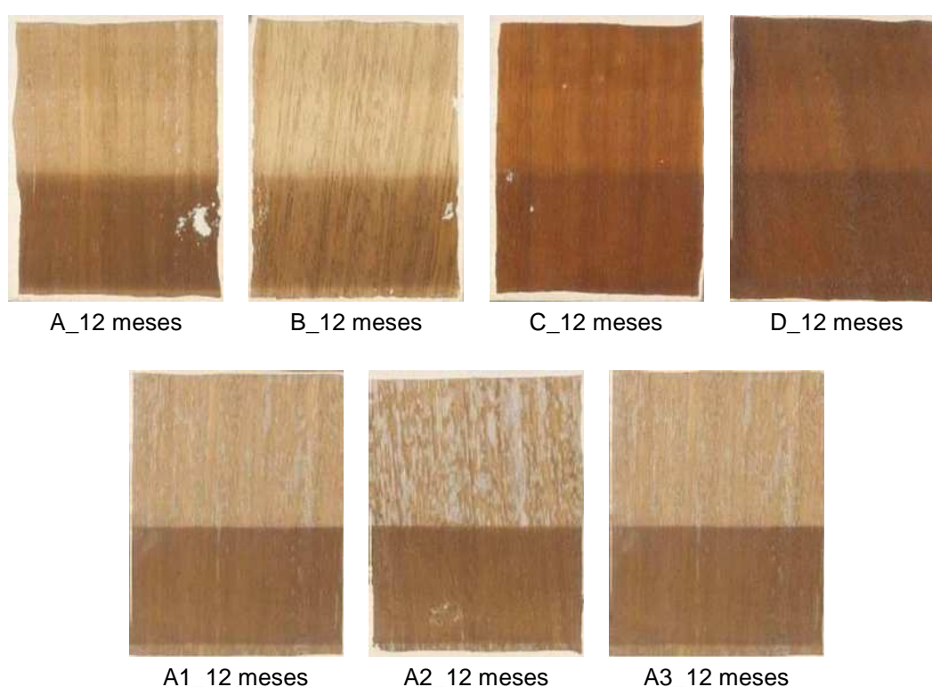
Figura 4.140. Probetas tras 12 meses de exposición. IROKO. Arriba, de izquierda a derecha, muestras A - B - C - D. Abajo, de izquierda a derecha, muestras - A1- A2 - A3.
