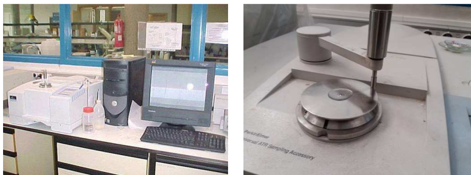
Figura 3.5. Espectrofotómetro FT-IR, Spectrum One de PerkinElmer Instruments.
