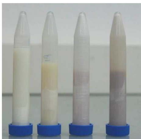
Figura 4.17. Mezclas con nanopartículas comparadas con el producto base tras 9 meses desde la mezcla (A - A1 – A2 –A3).
