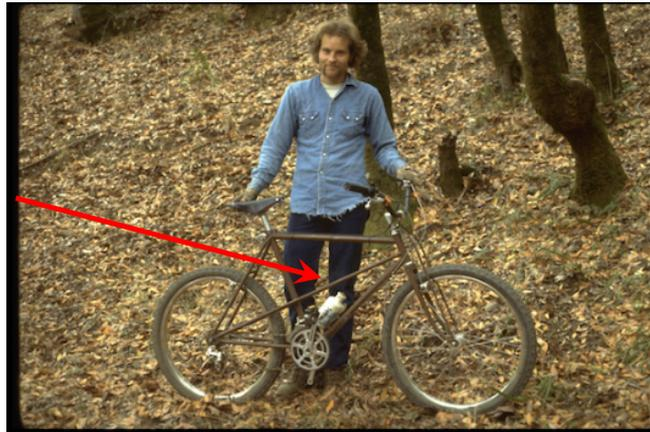
*Figura 2. Joe Breeze con su primera bicicleta de montaña, la “Breezer #1”, (Savage, 2007). Detalle del tubo de refuerzo señalado con flecha.*
