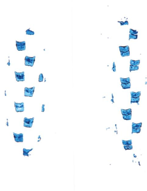
*Figura 4. Izquierda, huella de neumático de 26". Derecha, huella de neumático de 29"*
