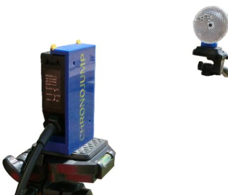
*Figura 14. Sistema de cronometraje con fotocélula, conectado a ordenador portátil y a batería, para el suministro de electricidad.*
