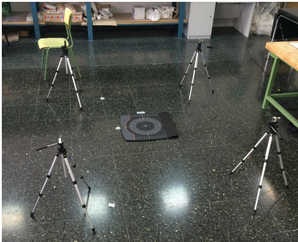
Figura 19. Disposición plataforma y fotocélulas en aula B-0.
