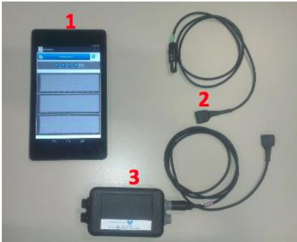
Figura 26. Equipo de acelerometría. 1. Tableta. 2. Acelerómetro. 3. Receptor.
