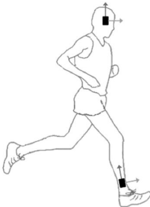
Figura 12. Posición acelerómetros en tibia y cabeza durante la carrera (62).
