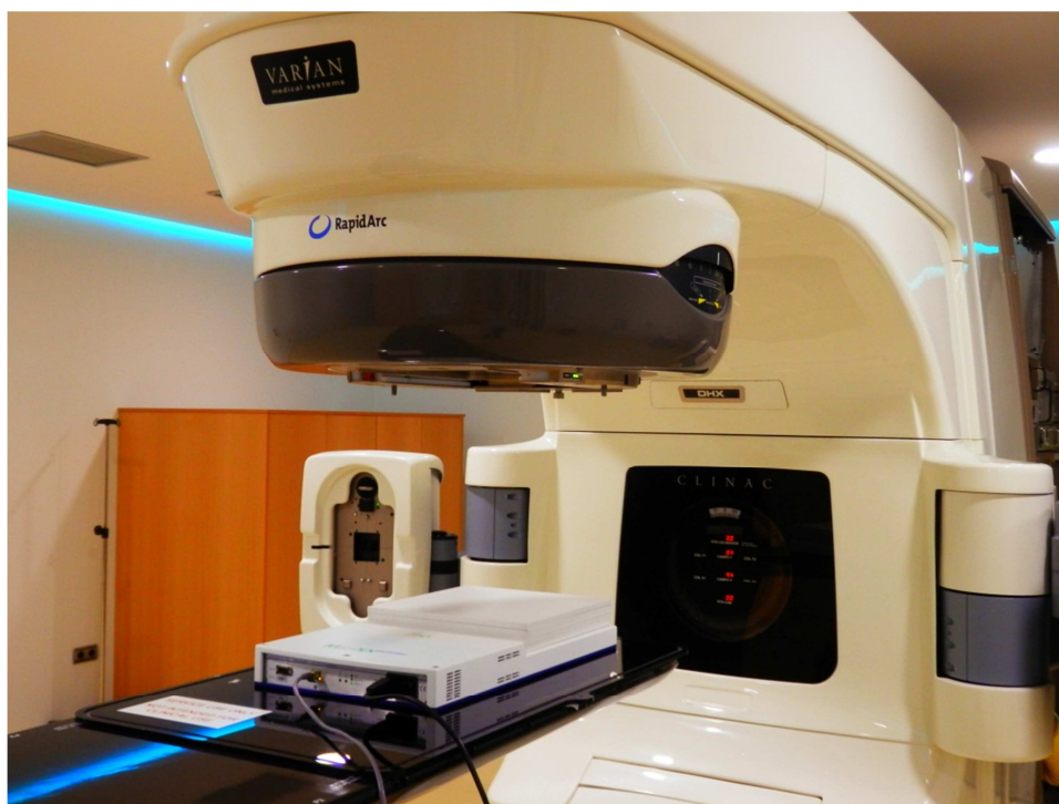
Figura 114. Colocación del MatriXX sobre la mesa de tratamiento para la obtención de las medidas de los planes de verificación.
