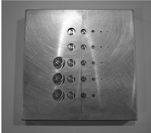
Figura 48. Imagen del maniquí las vegas, donde se pueden apreciar los diferentes orificios.
