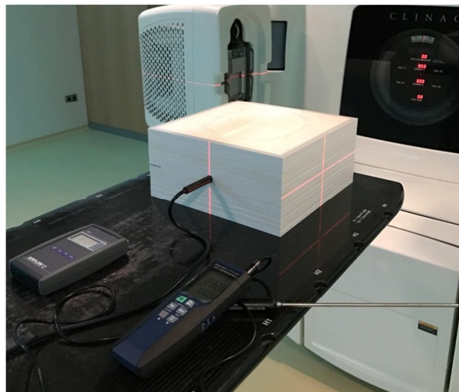
Figura 127. Montaje experimental para la verificación de la dosimetría de punto en tratamientos de IMRT.
