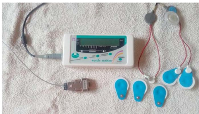
Figura 2.5. Equipo electromiográfico y electrodos.
