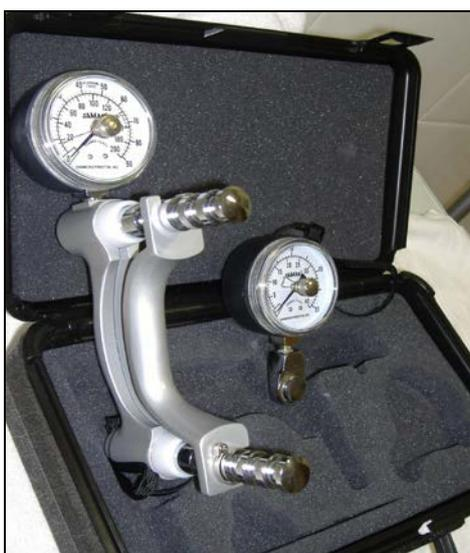
Figura 2.3. Dinamómetros de presión y pinza digital.
