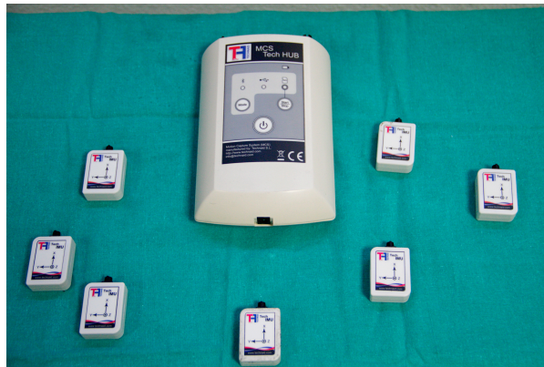
Figura 3. 2. IMUs y Unidad Tech HUB del equipo Tech MCS.
