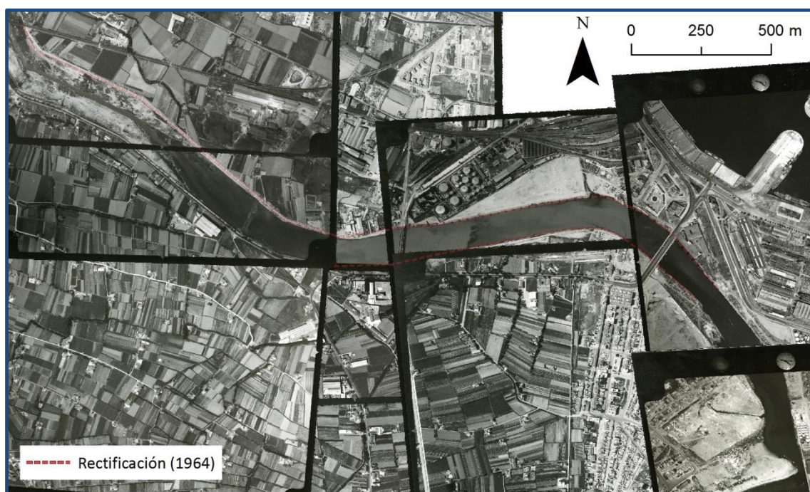
Fig. 10.3. Tramo de desembocadura tras las obras de rectificación (1964)
