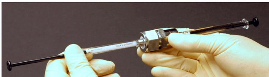
**Fig. 2.1: Método de extrusión de suspensiones lipídicas.** Este método es adecuado para preparar liposomas unilamelares de tamaños en el rango de decenas-centenas de *nm*, y consiste en la utilización de un mini-extruder comercial de Avanti Polar Lipid. La imagen ha sido tomada de <https://avantilipids.com/>.
