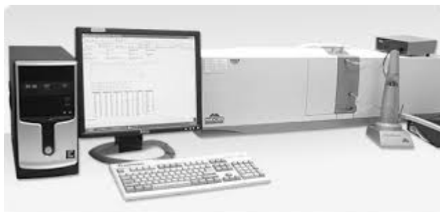
Figura 2.2.11. Analizador de tamaño de partículas Malvern Mastersizer 2000.
