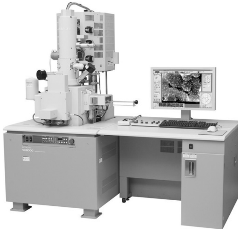
Figura 2.2.10. Equipo de MEB , Hitachi S-4800
