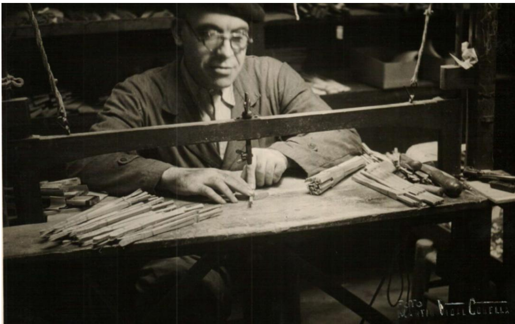
Calado del varillaje mediante una sierra de ballesta. C. 1940. Foto: M. Vidal Corella.
