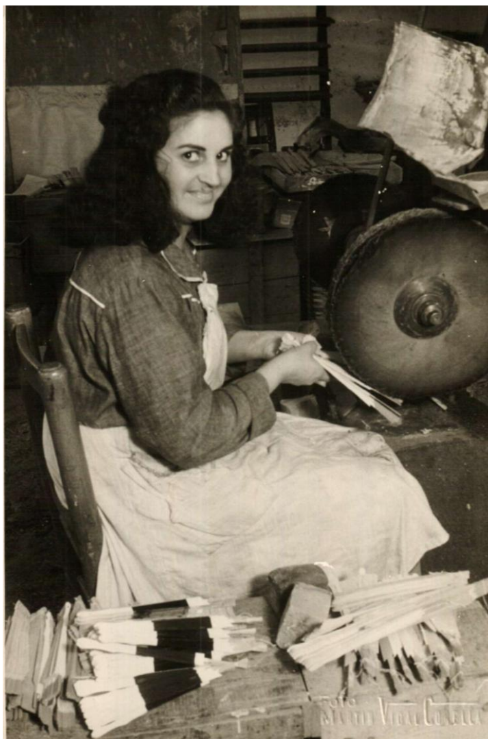
Muchacha pulimentando el varillaje. C.1940. Foto: M. Martín Corella.
