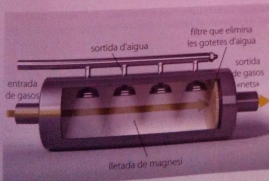
Figura 9.25 A les xemeneies de les centrals tèrmiques, s'hi instal·len filtres com aquest, en els quals el SO 2 que es produeix reacciona amb Mg(OH) 2 i es transforma en un sòlid:
