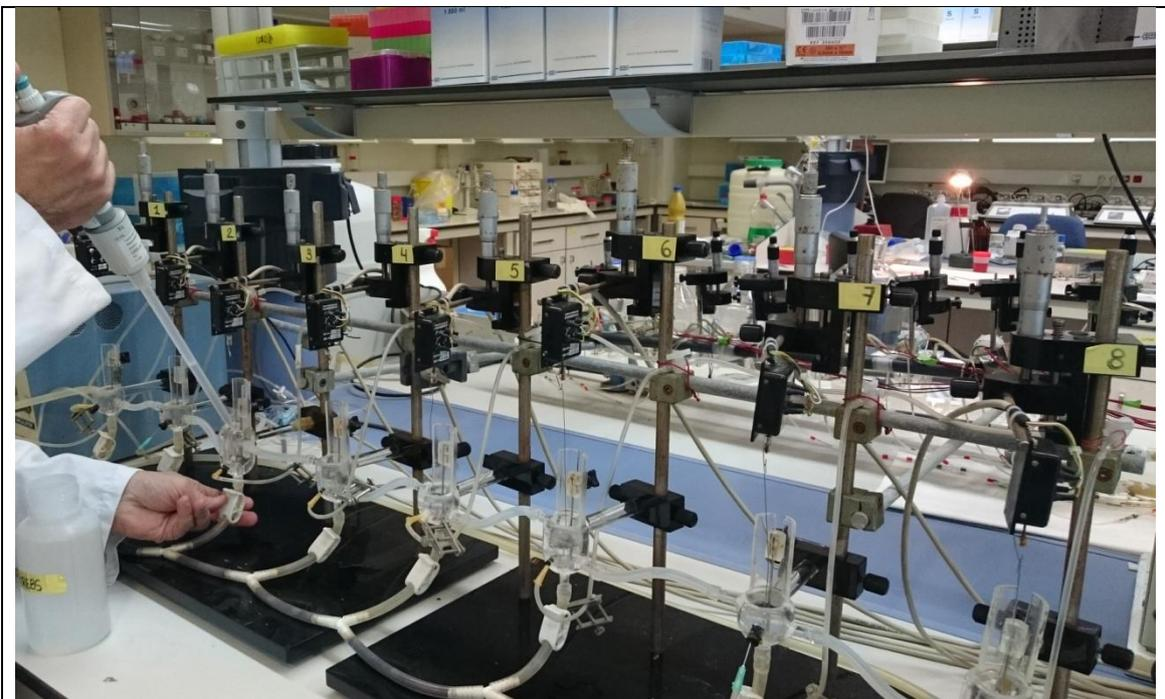
**Fig. 14** Sistema de baño de órganos en el banco del laboratorio
