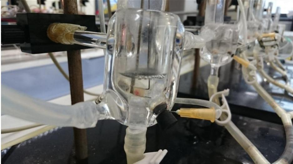
**Fig. 15** Doble copa de vidrio del baño de órganos con el anillo vascular posicionado para estudio.
