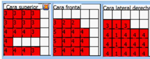
Figura 87. Actividad de tipo 3: Construir un sólido correspondiente a estas proyecciones ortogonales codificadas.
