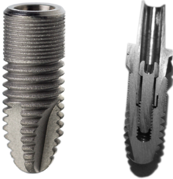
Figura 7. Figura representativa del implante Ticare® Inhex . Implantes con conexión interna cónica y doble hexágono con cambio de plataforma. Toda la superficie del implante esta tratada hasta la plataforma que termina con un bisel maquinado.
