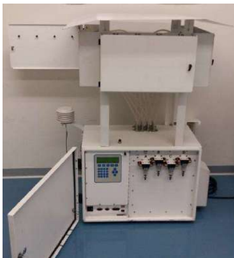
Figura 9. Captador Partisol 2300 de Bajo Volumen.
