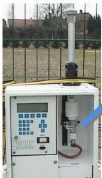
Figura 8. Captador Partisol 2000 de Bajo Volumen.
