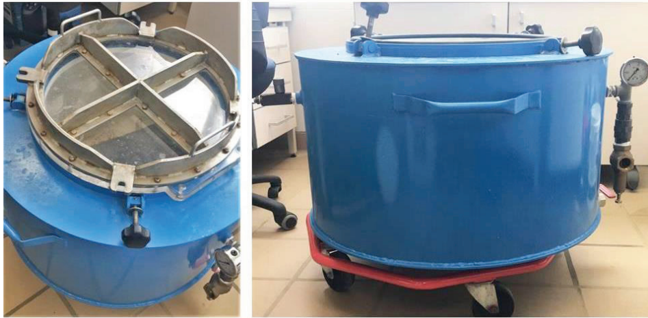
Figura 18.:Cámara hiperbárica del centro de recuperación Arca del Mar (Oceanográfico, Valencia) empleada en el tratamiento de tortugas marinas con enfermedad descompresiva.
