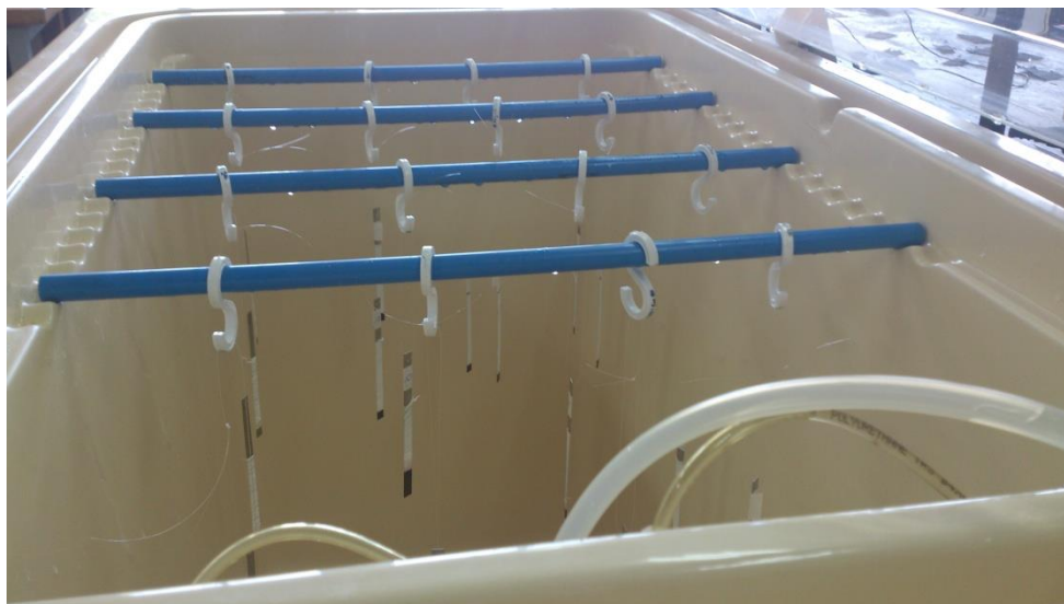
Imagen 9: Muestra la cámara de niebla salina con los electrodos introducidos en el interior antes de la realización del ensayo.
