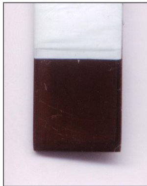
Imagen 8: Depósito de PNR sobre SS304 después de 90 ciclos voltamperométricos a 100 \text{ mV}\cdot\text{s}^{-1} en medio \text{K}_2\text{SO}_4 0.03 M a pH 1.6 y temperatura de 298 K.
