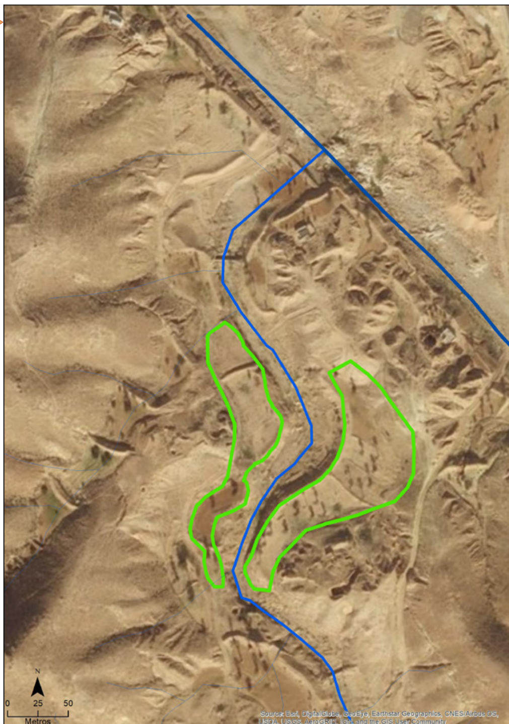
Figura: Aprovechamiento de las aguas concentradas fuera del cauce, mgoud o boqueras, en la desembocadura de la cuenca de oued el Haddej, Matmata, Túnez.
