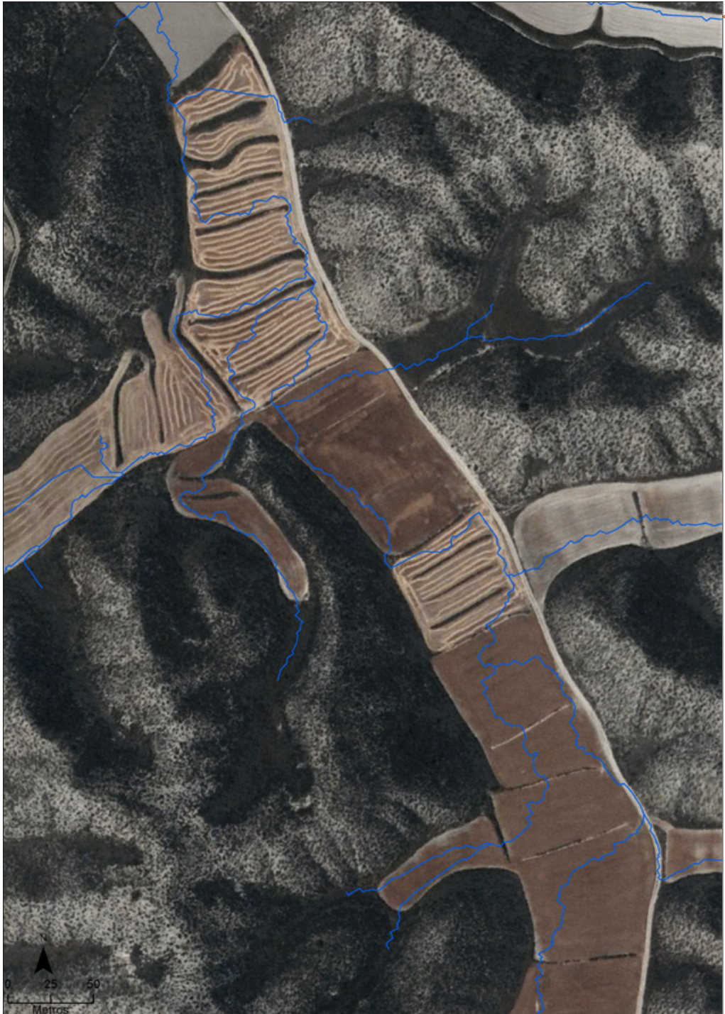
Figura: Dirección de los flujos en algunos bancales en la cuenca de la Val de Huerva (Valmadrid, Zaragoza). Fuente: Elaboración propia.
