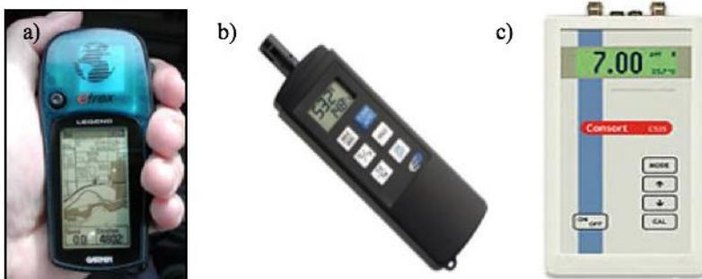
Figura 43.- a) GPS, b) termómetro ambiental digital y c) multiparámetro portátil.
