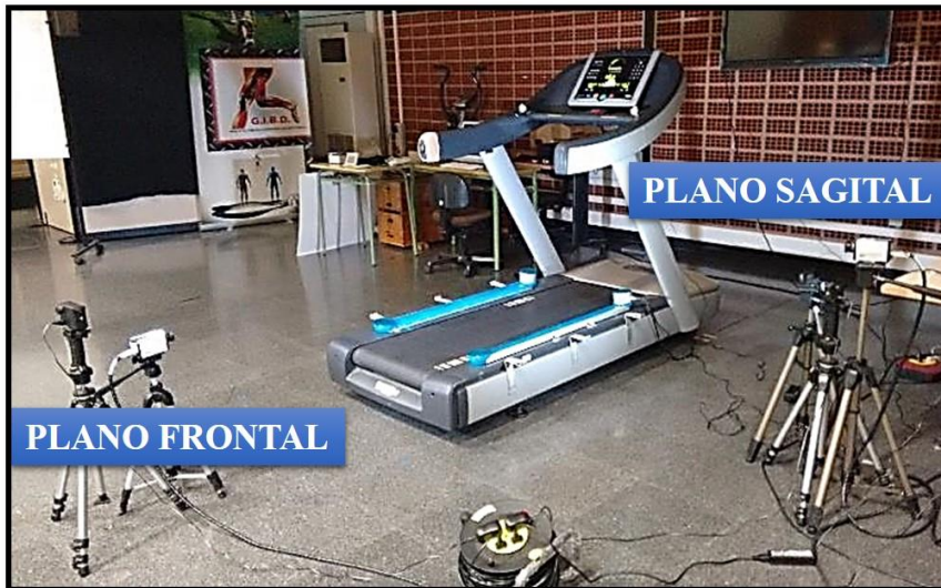
Figura 25. Colocación de las cámaras para el análisis de la fotogrametría.
