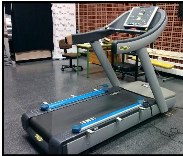
Figura 28. Colocación de las barras LED del OptoGait en el treadmill.
