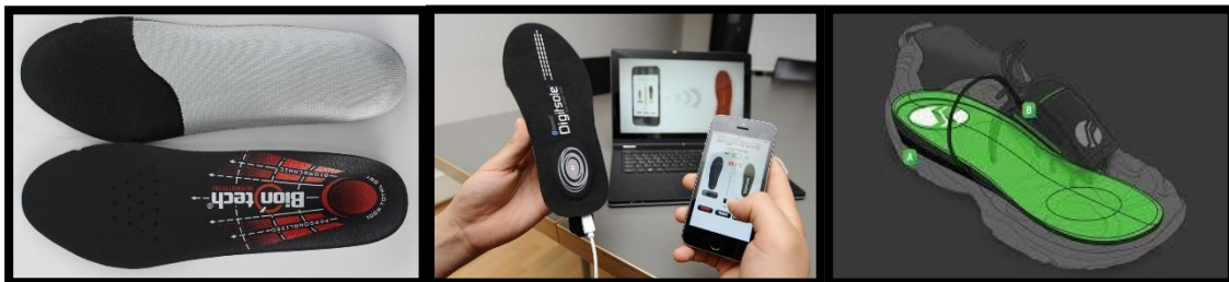
Figura 10. Ejemplos de soportes plantares novedosos. Soporte plantar prefabricado termoconformable (izquierda); soporte plantar “ wearable ” (centro) y soporte plantar generador de energía (derecha).
