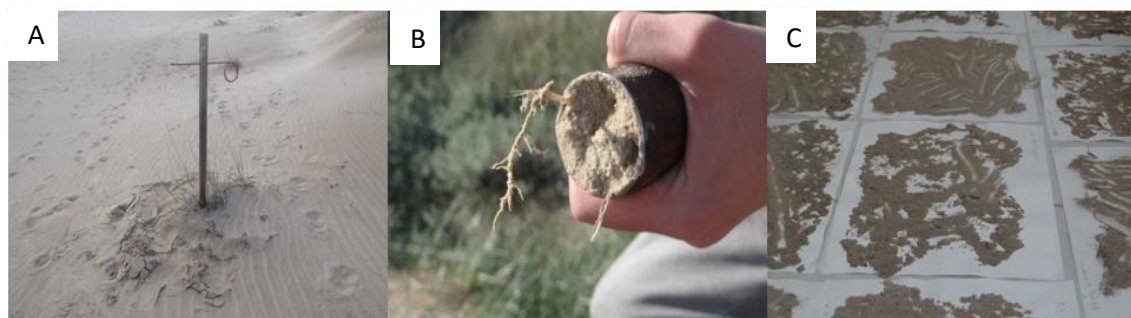
Figura 2.4. Muestreo en el campo (A y B) y secado de muestras a temperatura ambiente (C).
