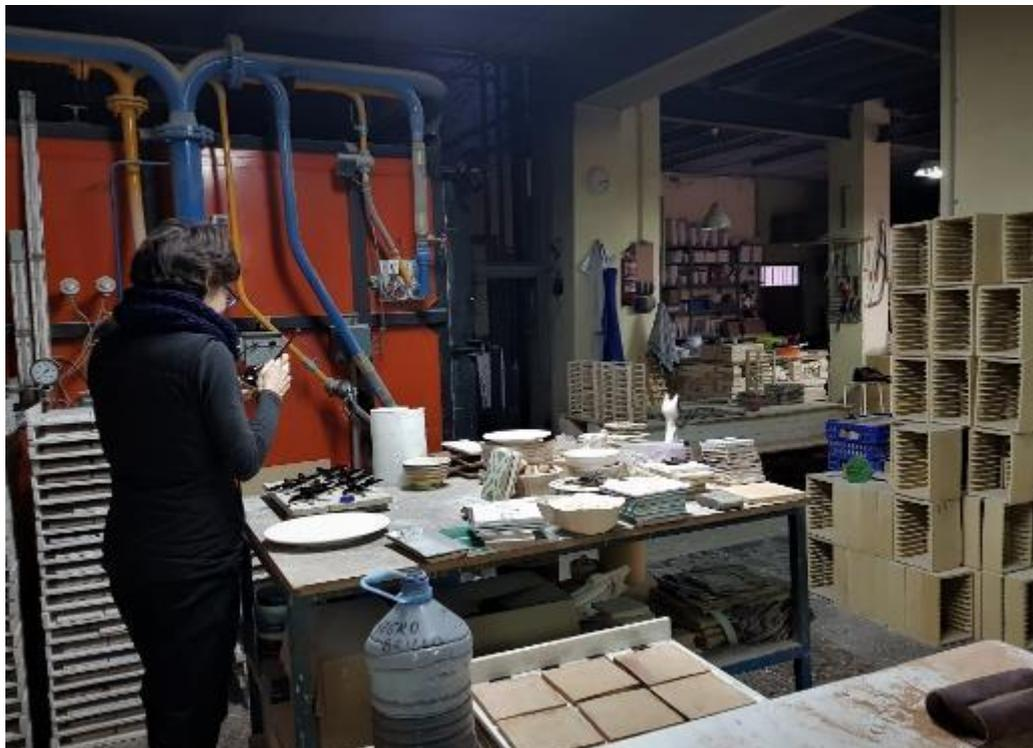
Zona de hornos, izquierda horno eléctrico de 50 x 50 x 50. Derecha horno de gas de 2 m<sup>3</sup>. Fuente propia.
