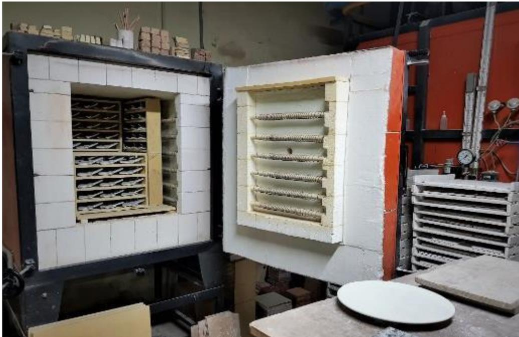
Detalle de la parte frontal del horno de gas de 2 m<sup>3</sup> y de vagoneta de carga. Sobre la misma aparecen soportes refractarios para platos o azulejos. Fuente propia.
