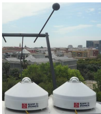
Figura 2.2: Piranómetros CMP21 en seguidor solar SOLYS-2 de Kipp and Zonen, la bola de sombra se emplea para la medida de radiación difusa.
