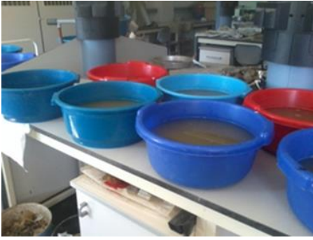
Fig. 2.2.1.- Muestras diluidas en abundante agua caliente y preparadas para su manipulación tras las 24 horas de deposición.
