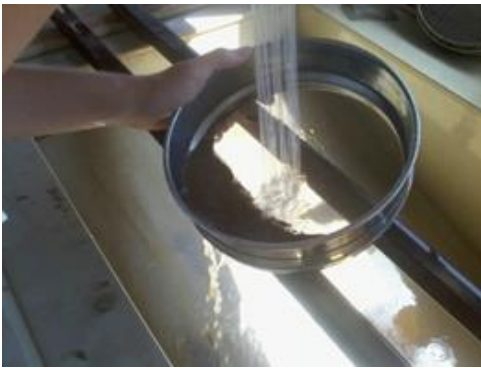
Fig. 2.2.2.- Sedimento en tamiz de 0,063 micras bajo abundante agua a presión para su lavado.
