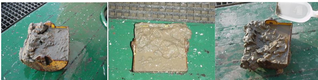
Fig. 2.1.1.- Imágenes parte inferior de la draga Shipek llamada “cuchara”, con el material recolectado para las muestras S-3(02), S-4(02) y S-5(02), se pueden observar que son lutitas arenosas de color grisáceo.
