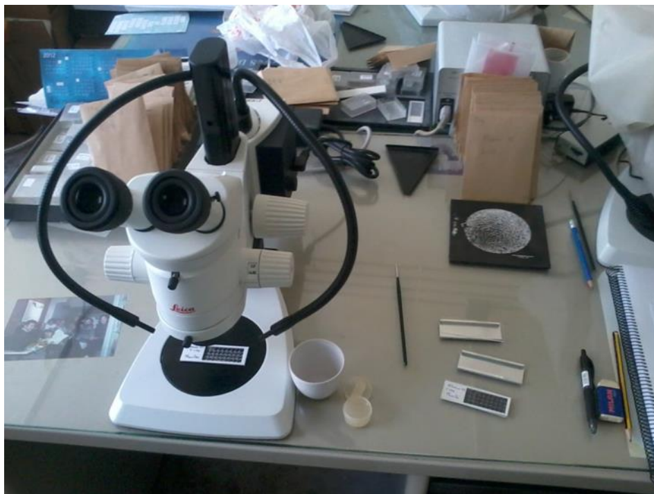
Fig. 2.2.4.- Lugar de manipulación con los sobres de las muestras en el fondo y utensilios para la manipulación de los foraminíferos.
