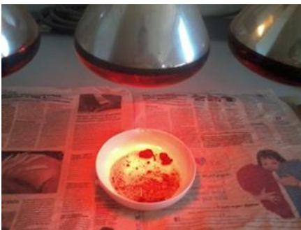
Fig. 2.2.3.- Muestra en fase de secado, bajo luz infrarroja.
