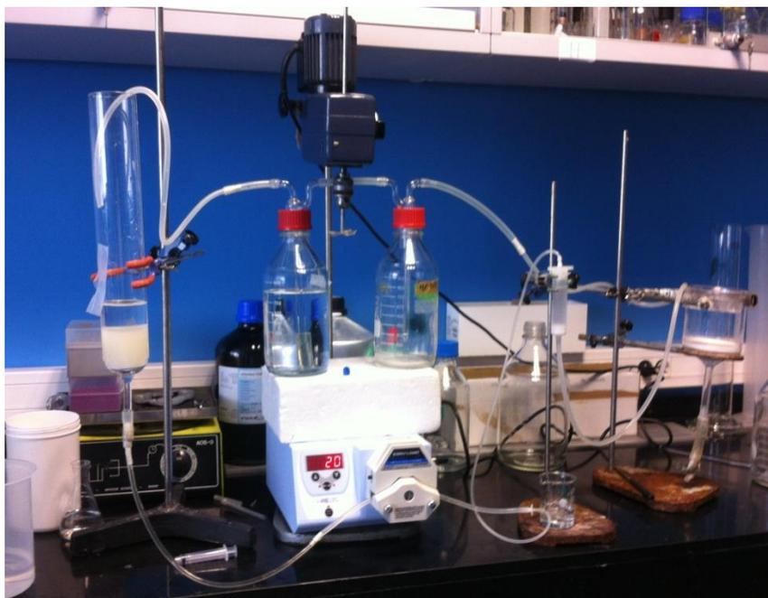
**Figura 2.5.** Purificación en el laboratorio de las moléculas inhibitorias de *S. dentisani* con el uso de resinas C18 55-105 UM 125A y CM Sephadex C-25.
