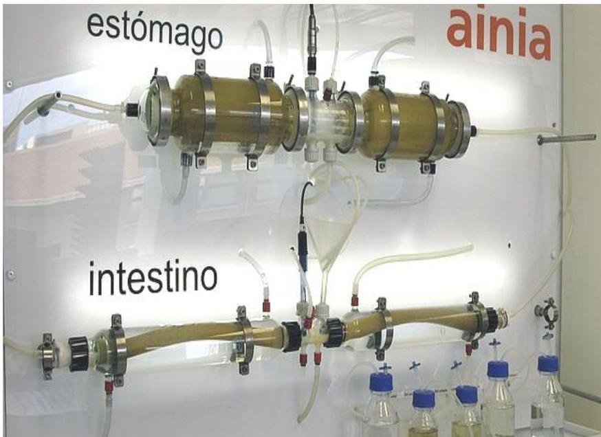
**Figura 4.2.** Imagen del Digestor Dinámico *in vitro*. AINIA Centro Tecnológico
