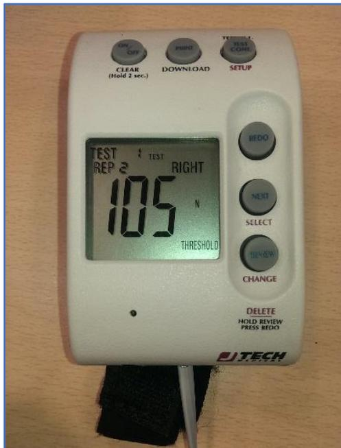
Imagen 11: Dinamómetro de muñeca Commander Muscle Testing (vista del transductor y pantalla principal).
