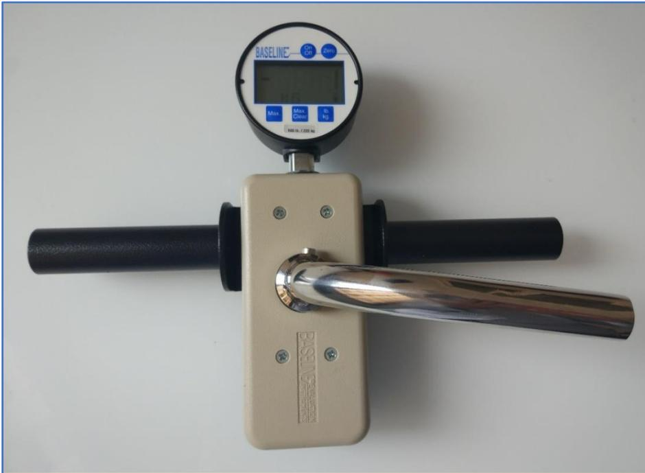
*Imagen 12b: Dinamómetro de torsión Baseline Hydraulic Wrist Dynamometer.*
