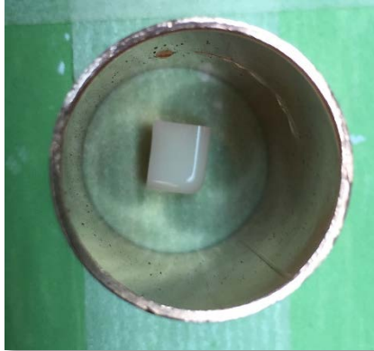
Fig. 7: Bloque de IPS e.max CAD® en el interior del cilindro de cobre para ser embutido en escayola.
