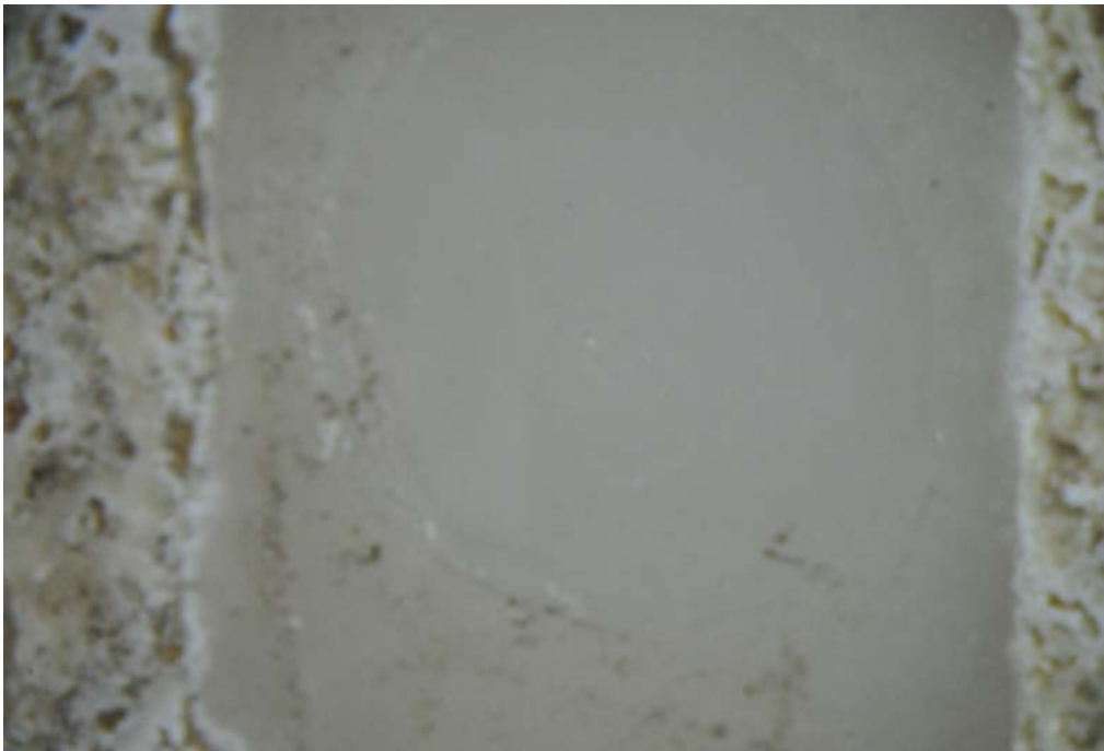
Figura 15. Fractura de tipo adhesivo vista a microscopía óptica a 10 aumentos. Véase la superficie del material de base (IPS e.max CAD®) sin restos de cemento ni pérdida de material cerámico.
