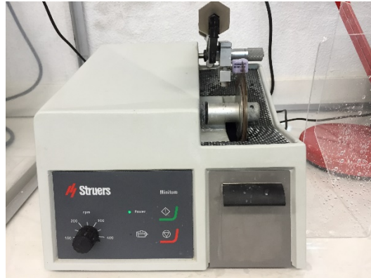
Fig. 2: Corte de los bloques para obtener los prismas de material restaurador.
