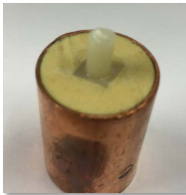
Fig. 10: Imagen del cilindro de composite cementado sobre el bloque de material.
