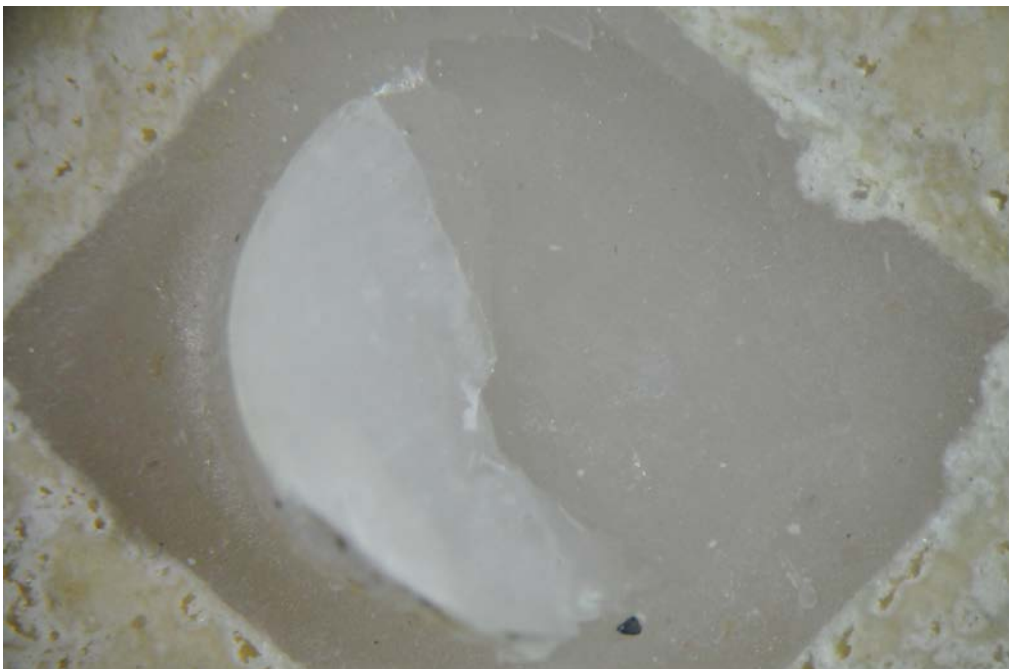
Figura 16. Fractura de tipo mixto. Se aprecia parte del cilindro de cemento de composite (Variolink II®) adherido al material restaurador (IPS e.max CAD®). Imagen 10x.
