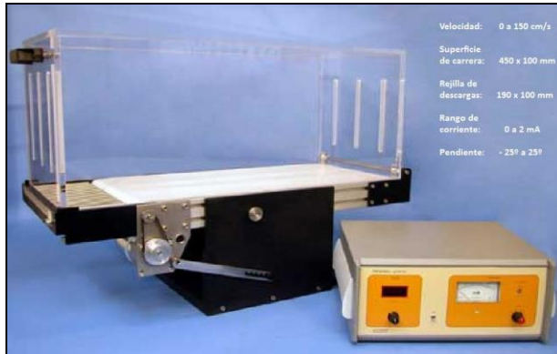
Figura 2.2. Tapiz rodante y unidad de control.
