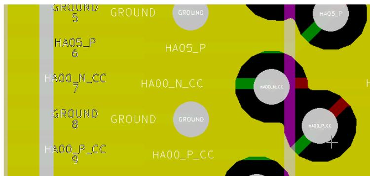
Fig. XI.5 - Vista de los *anti-pads* para las vías de las señales diferenciales en el conector J6 (HDMI). La capa interna GND es de color amarillo en el diseño KiCad, vías de color gris y pistas de color rojo y verde.
