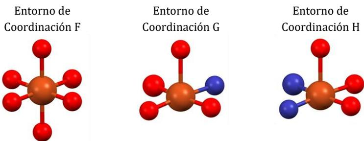
**Figura 6.34.** Entornos de coordinación de los átomos de cobre presentes en la estructura cristalina 7. Nitrógeno, en azul. Oxígeno, en rojo. Cobre, en naranja.
